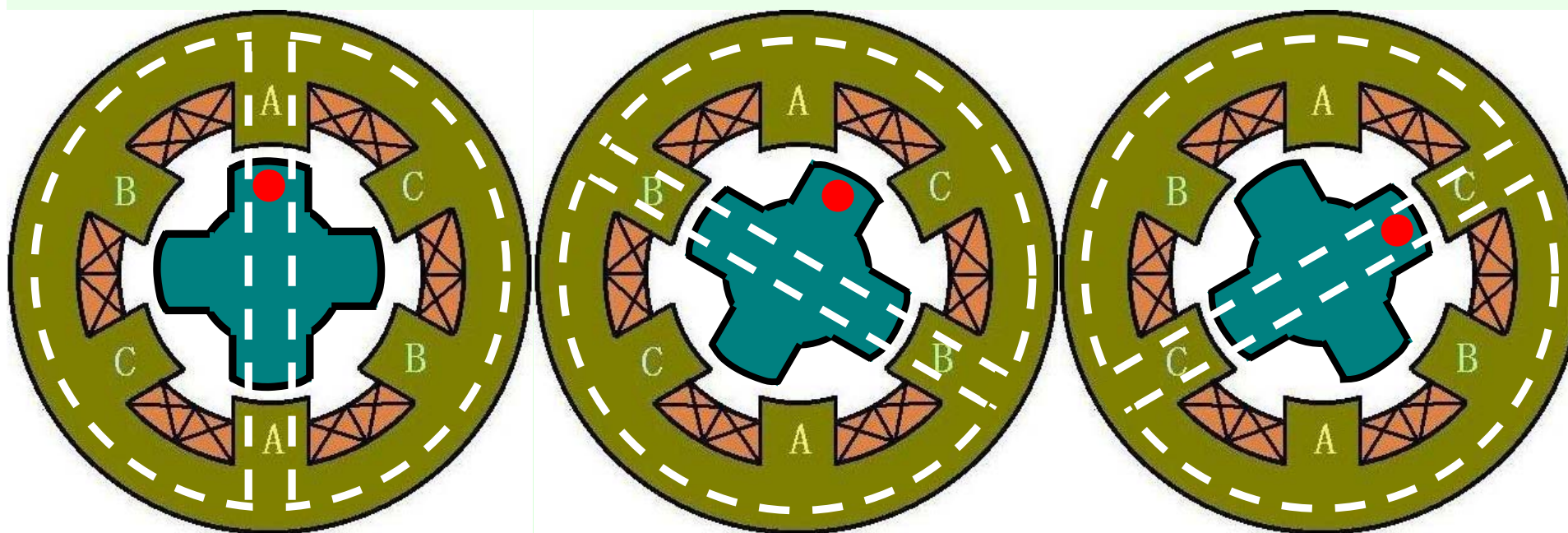
三相反应式步进电动机的工作原理图
