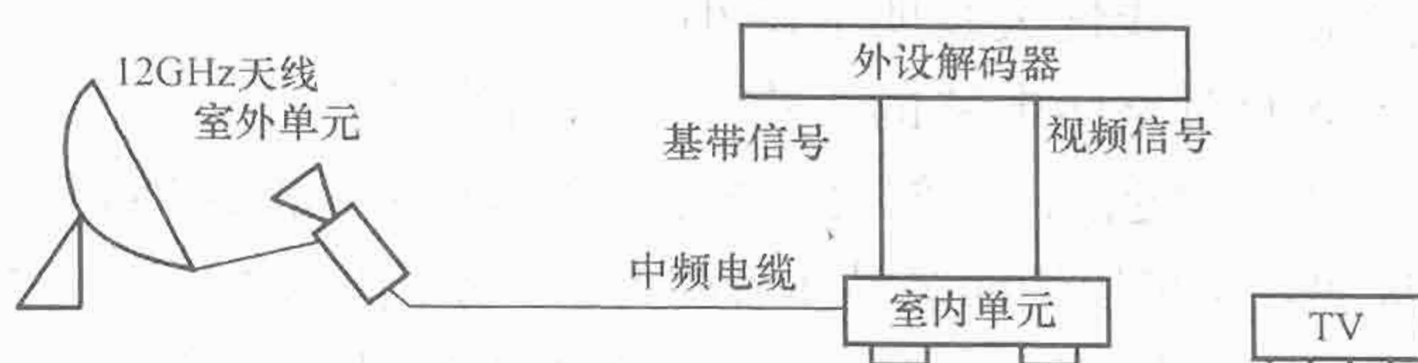
图 9-10 12GHz 接收站连线图
