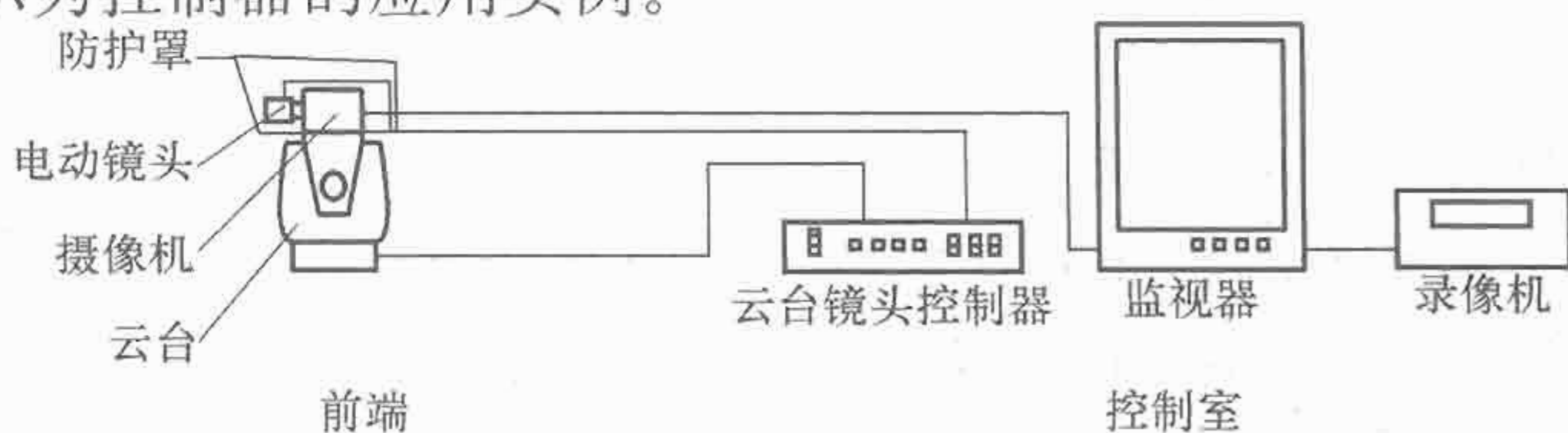
图 2-11 具有云台、电动镜头及控制的小型系统
