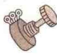
旋转电位器的旋钮可方便调节输入电压
