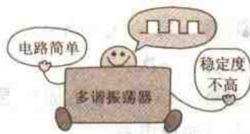
**博士** 是这样。要求较高稳定度时,可采用晶振的振荡电路。
