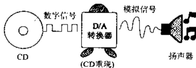
**小明** 歌手的歌声原来是连续的模拟信号,若将它变换为 0 与 1 组成的断续数字信号,能否将最初的平滑声音数据变换为完整的形式呢?
