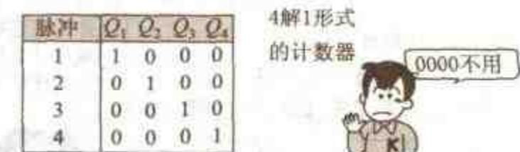
**博士** 这样,对于环形计数器,用  $n$  个触发器级联就构成  $n$  进制计数器。
