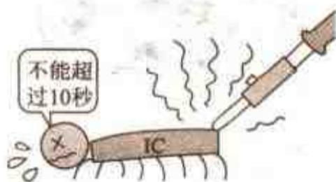
集成电路耐热的最大定额通常是温度  $260^{\circ}\text{C}$ 、时间 10 秒。烙铁温度是  $250\sim 300^{\circ}\text{C}$ ,因此,若超过 10 秒会引起管脚发热,则可能损坏集成电路。
