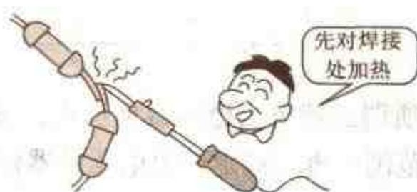
② 保持在原地不动,使焊锡在烙铁头与焊接处适量熔化。
