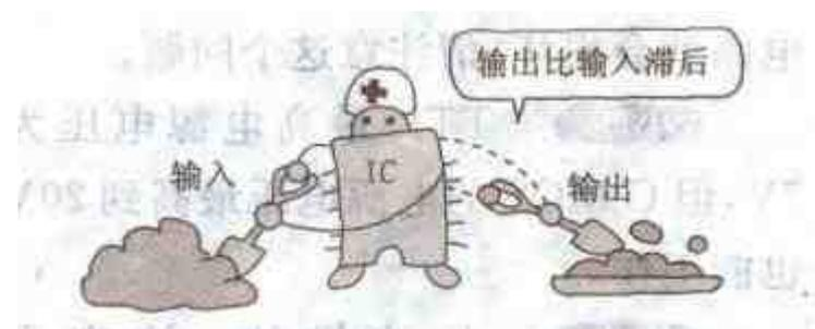
**小明** 从现在开始, 考虑为正逻辑电路, 即电压 0V 为逻辑电平 0, 5V 为逻辑电平 1。对于实际的数字集
