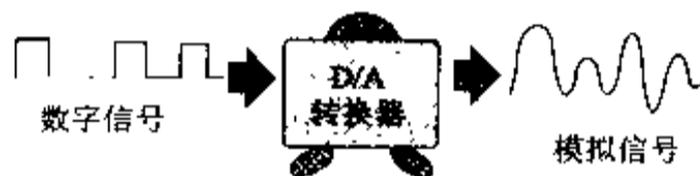
音乐记录到 CD 上时,使用 A/D 转换器,反之,将记录在 CD 上的音乐重现时使用 D/A 转换器。
