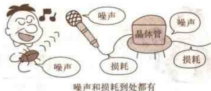
由于这些噪声的影响，原来的信号失去了本来面目。另外，信号在电路中传播时，导线的电阻减弱了传播的信号，这称之为损耗。尤其模拟信号容易受到噪声与损耗的影响。
