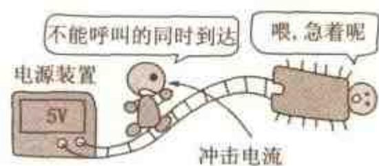
这时,若在集成电路近旁接入电容器,需要的冲击电流从电容器中取出。电容器相当于电源。
