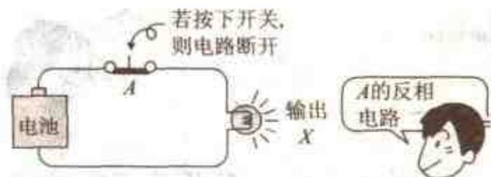
开关电路中将开关按下(1),没有输出电压。非门电路也称为非门,或称反相器。
