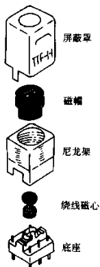
图 7-9 中频变压器的外形图和内部结构示意图
