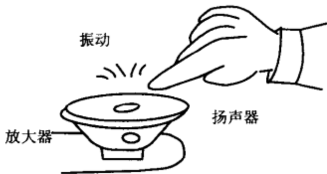
图 3.223 作为换能器的扬声器
