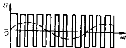
图 9-13 脉宽调制变频器的电压波形
