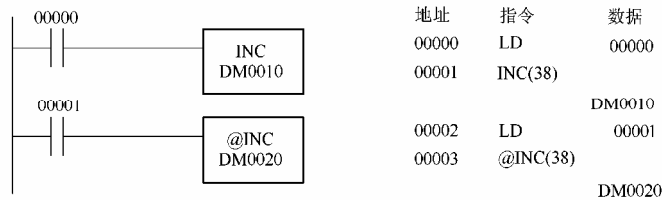
图 5-42 INC 梯形图及助记符示例
