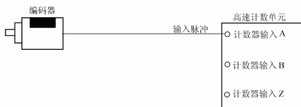
图 3-40 预置值计数模式下的增减脉冲输入示例
