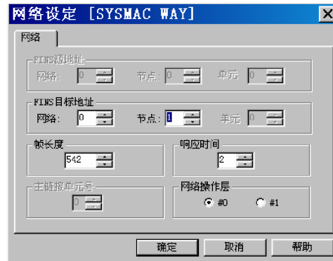
图 7-23 a2 网络配置对话框
