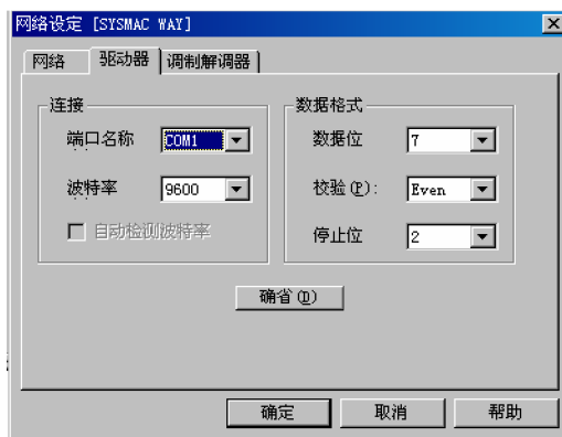
图 6-6 PLC 网络配置
