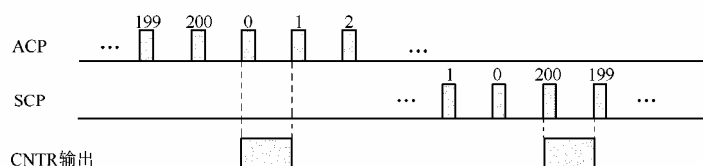
图 5-20 可逆计数器的信号动作过程（计数设定值 0200）
