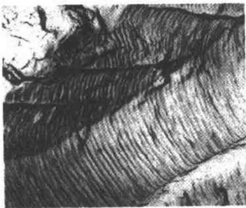
图 11-23 铝合金疲劳断口透射电镜照片
