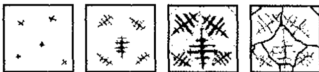
图 6-2 纯金属结晶示意图
