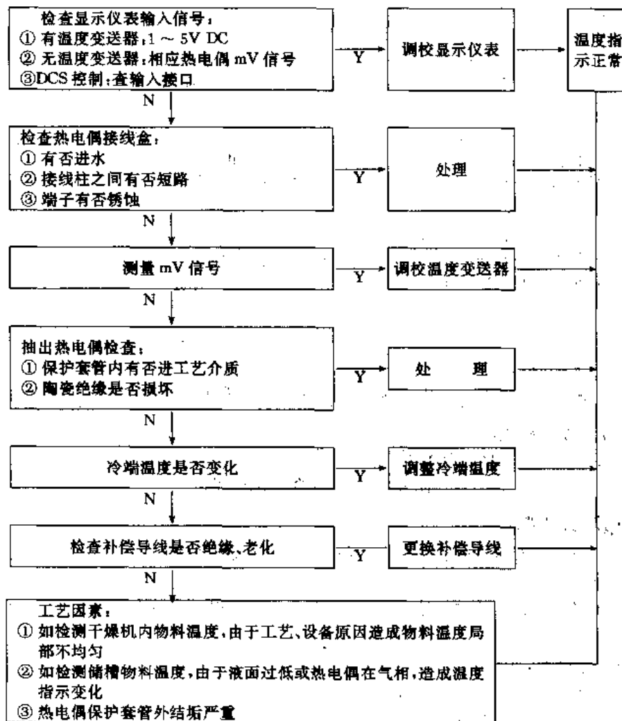
图 6-2-1 温度检测故障判断
