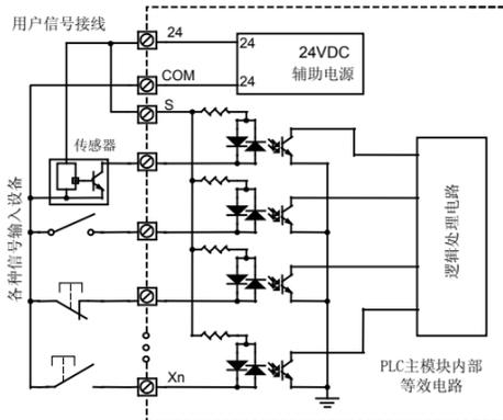
图7 漏型输入接法
