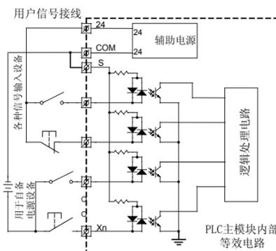
图8 源型输入接法
