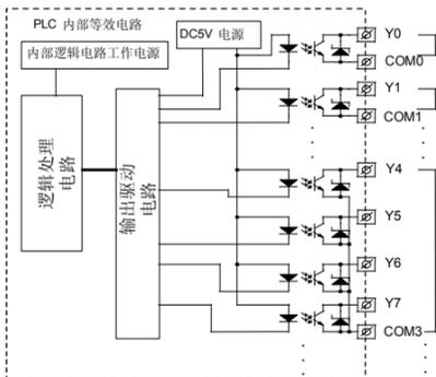
图9 晶体管输出内部等效电路
