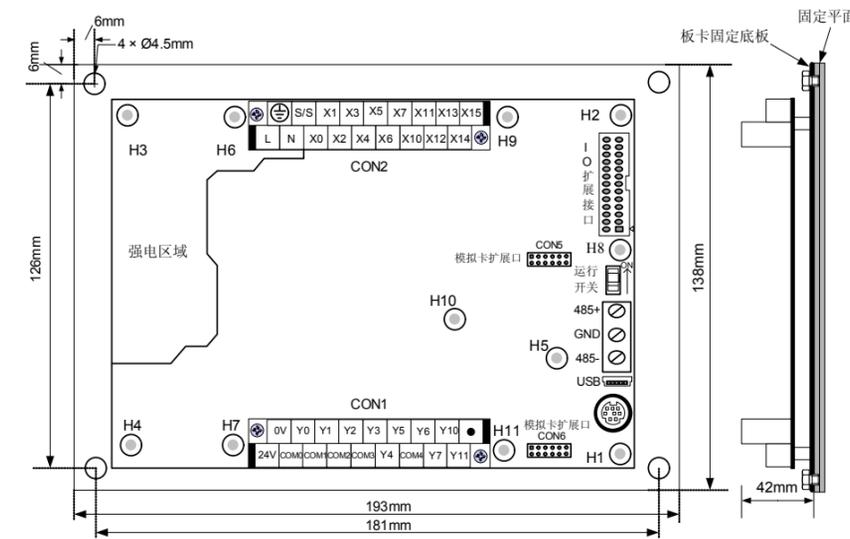
图2 NXXA1410MTAZ 板式PLC尺寸及硬件分布图
