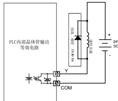
图10 感性负载吸收电路示意图
