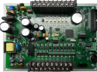
图1 NXXA1410MTAZ 板式PLC外观图
