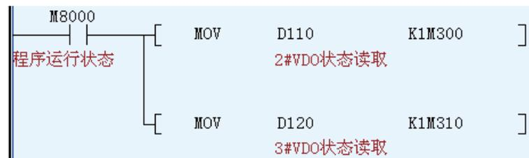
2# 伺服通过从站 CAN 发送配置将 H17-32 的状态发送到 PLC 的 D110，同理，3# 伺服发送到 PLC 的 D120。触发方式是时间触发，触发条件是 10ms，即每隔 10ms 发送一次。
