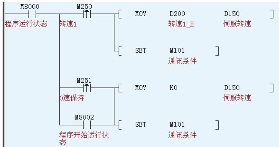
速度变量的单位是 rpm，通过主站 CAN 发送配置发送到伺服 H06-03，触发方式是事件触发，触发条件是 M101。
