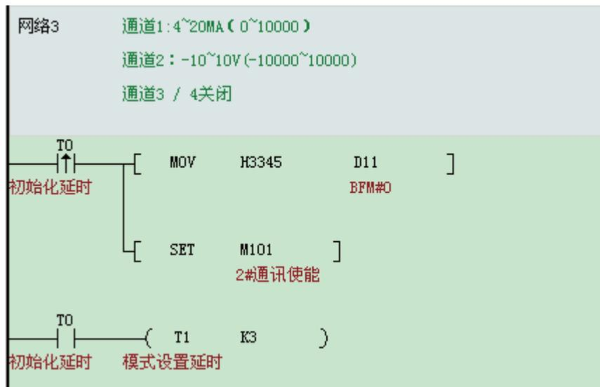
主站 CAN 发送配置将 PLC 的 D11 传送到 H2U-4ADR 模块的 BFM#0 中，触发方式是事件触发，触发条件是 M100，即 M101 为 ON，发送一次。发送完成后 M101 自动复位。
