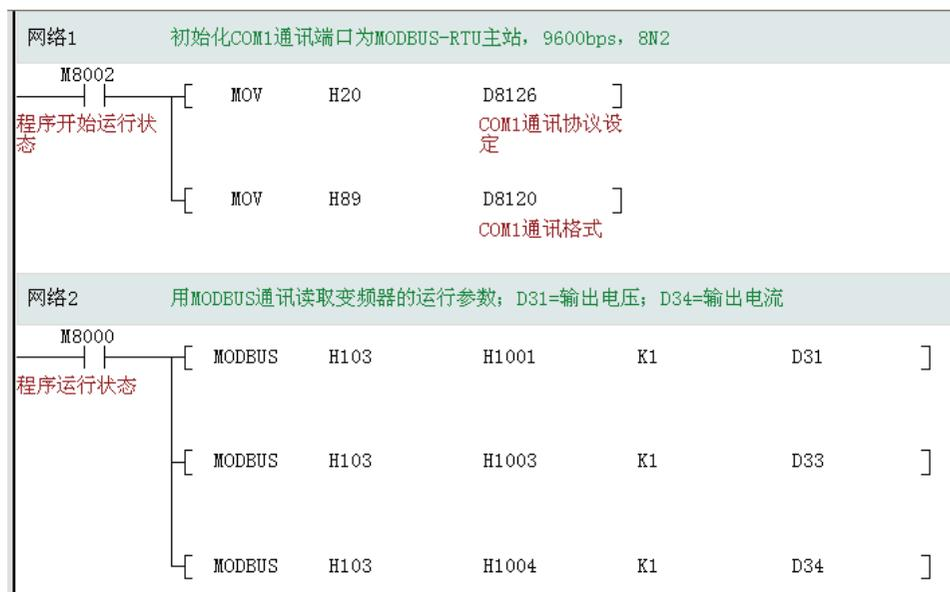
MODBUS 指令可以同时存在多条并且全部被驱动, 系统内部会协调指令的顺序执行, MODBUS 协议要求无论写还是读, 从站均需要有应答 (广播除外)。一条 MODBUS 指令可能需要执行较长时间, 一般需要多个扫描周期。在一个扫描周期内, 指令被驱动, 但不一定被执行。
