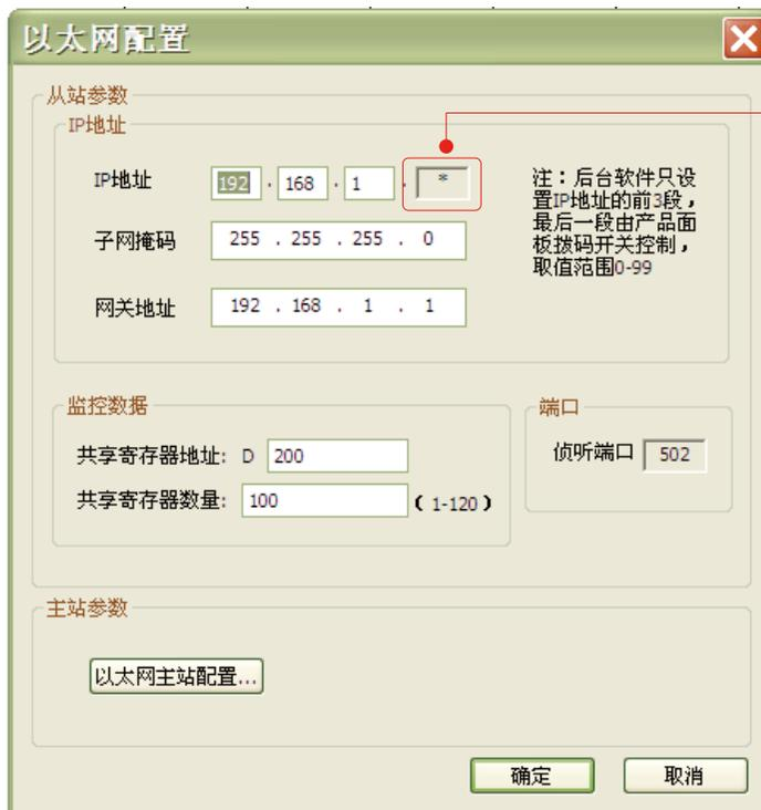
PLC的IP地址的末端，该数值只能在连接到PLC外部的以太网卡上进行设置
