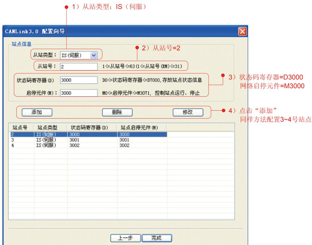
配置从站的参数有: 站号、网络启停 M(控制本站网络启停)、状态码寄存器 D(反馈本站网络状态)。然后点击“添加”。
