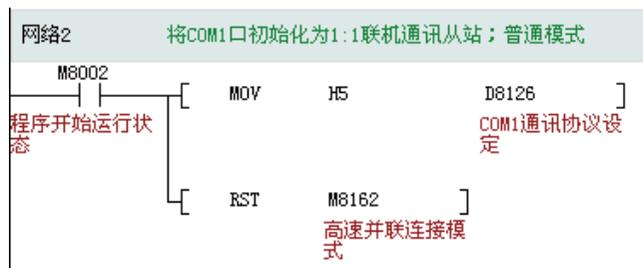
和其他通信协议的设置方法一样，PLC 是以第一次扫描完用户程序时的 D8126、D8120、M8162 等特殊寄存器的数值和状态，作为运行时的端口协议设置，运行过程中，修改这些寄存器或 M 变量，对各端口的通信协议没有影响，除非重新启动 PLC 的程序运行。
