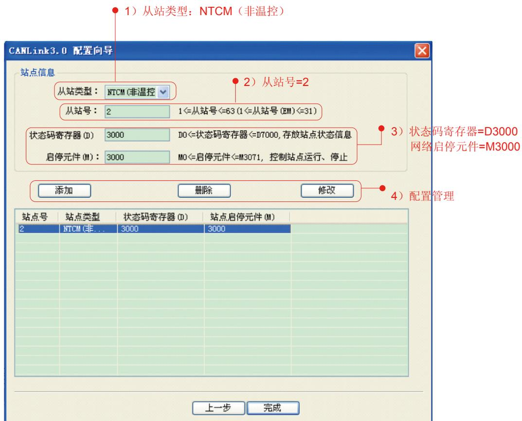
配置从站的参数有: 站号、网络启停 M(控制本站网络启停)、状态码寄存器 D(反馈本站网络状态)。然后点击“添加”。
