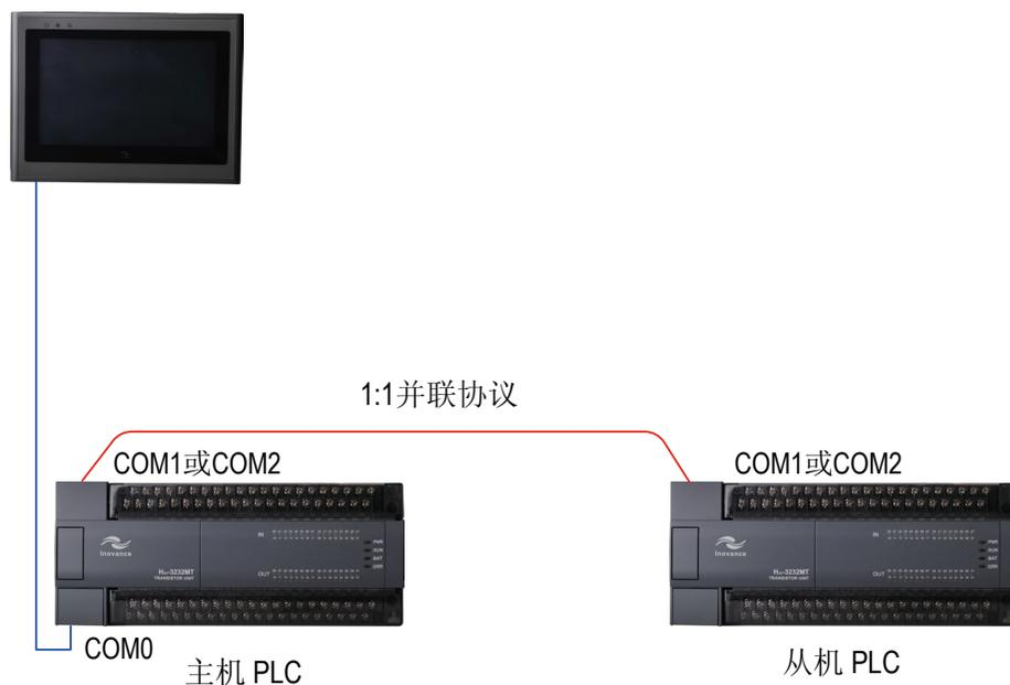
由于主机和从机 PLC 并联通信的数据较少，HMI 分别和每一台 PLC 通信，直接在 HMI 上设置各自 PLC 的参数。PLC 之间只通信实时性较高的信号和数据。
