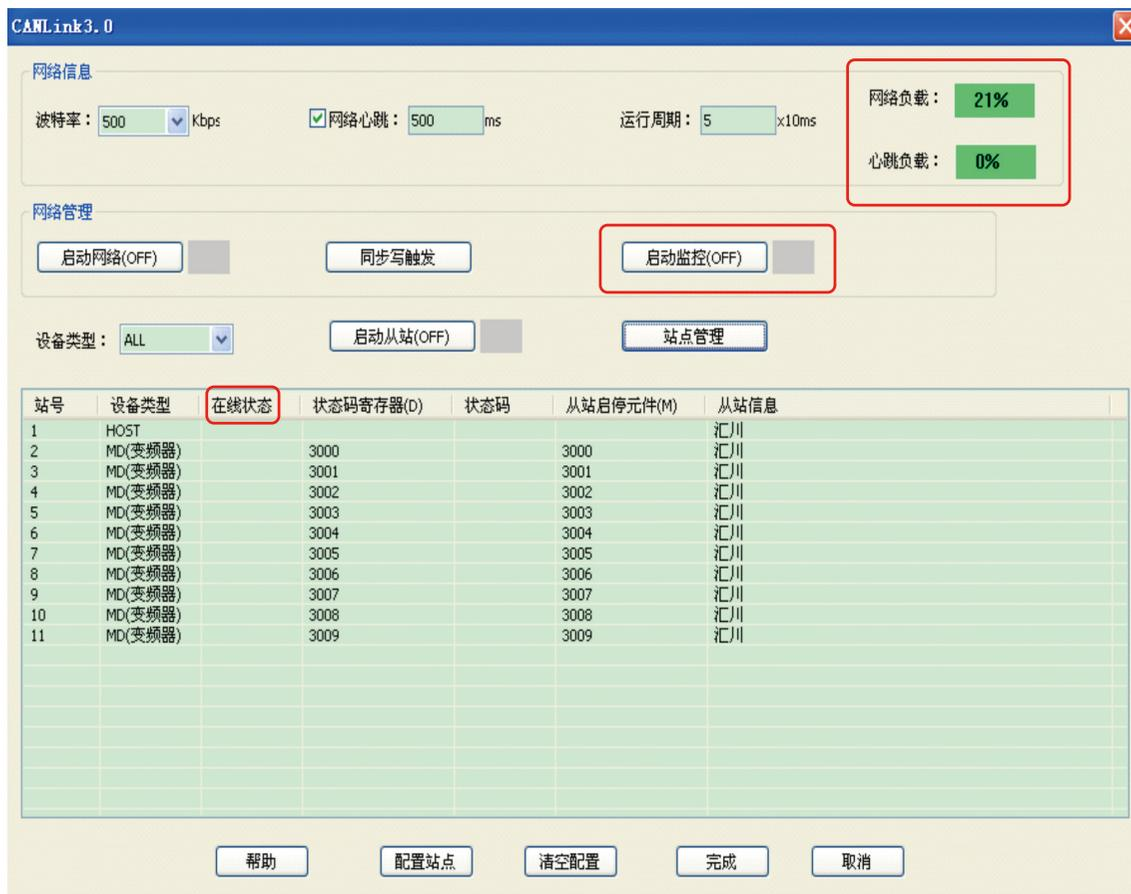
PLC 运行时，可以启动网络监控，查看“在线状态”、“网络负载”和“心跳负载”，网络负载必须控制在 75% 以内，心跳负载在 10% 以内。
