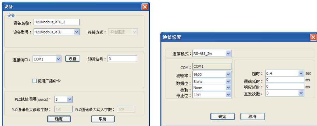
1) PLC 通信端口设置
