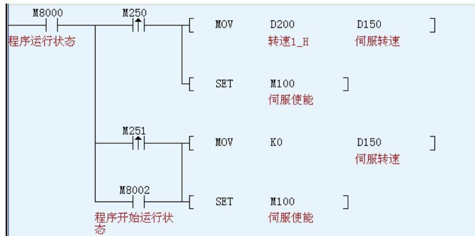
速度变量的单位是 rpm，通过主站 CAN 发送配置发送到伺服 H06-03，触发方式是事件触发，触发条件是 M100。
