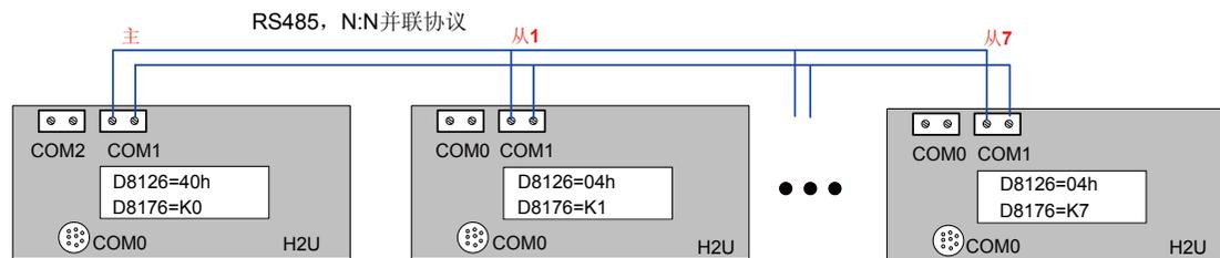
在 N:N 通信网络中，要设置 1 个通信主站，其他的 PLC 均为通信从站。主站负责发起通信，监控各通信从站的状态。
