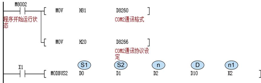
例如将 Ⓝ1 设置为 K2，则本条 MODBUS2 指令用于对 COM2 通信口的通信操作
