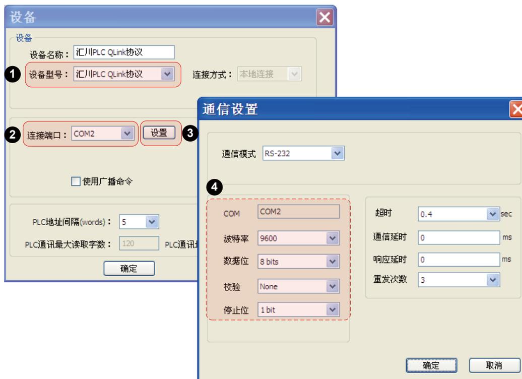
H2U-XP 的 COM0/COM1/COM2/COM3 端口都可以作为汇川 PLC Qlink 协议，在 AutoShop 中对 PLC 与 HMI 通信的端口，则要将该端口选择为汇川 PLC Qlink 协议，注意 HMI 与 PLC 两侧的通信波特率、数据格式要设定的一致，如图中虚线框内的选项。
