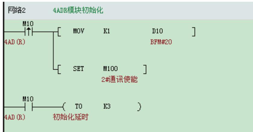
主站 CAN 发送配置将 PLC 的 D10 传送到 H2U-4ADR 模块的 BFM#20 中，触发方式是事件触发，触发条件是 M100，即 M100 为 ON，发送一次。发送完成后 M100 自动复位。
