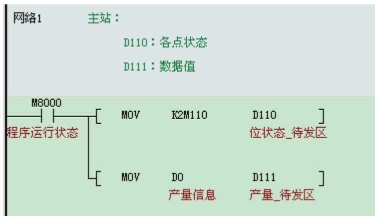
主站的 D110,D111 内容需要发往 2# 从站的 D100,D101。发送方式为时间触发，触发条件 10ms。
