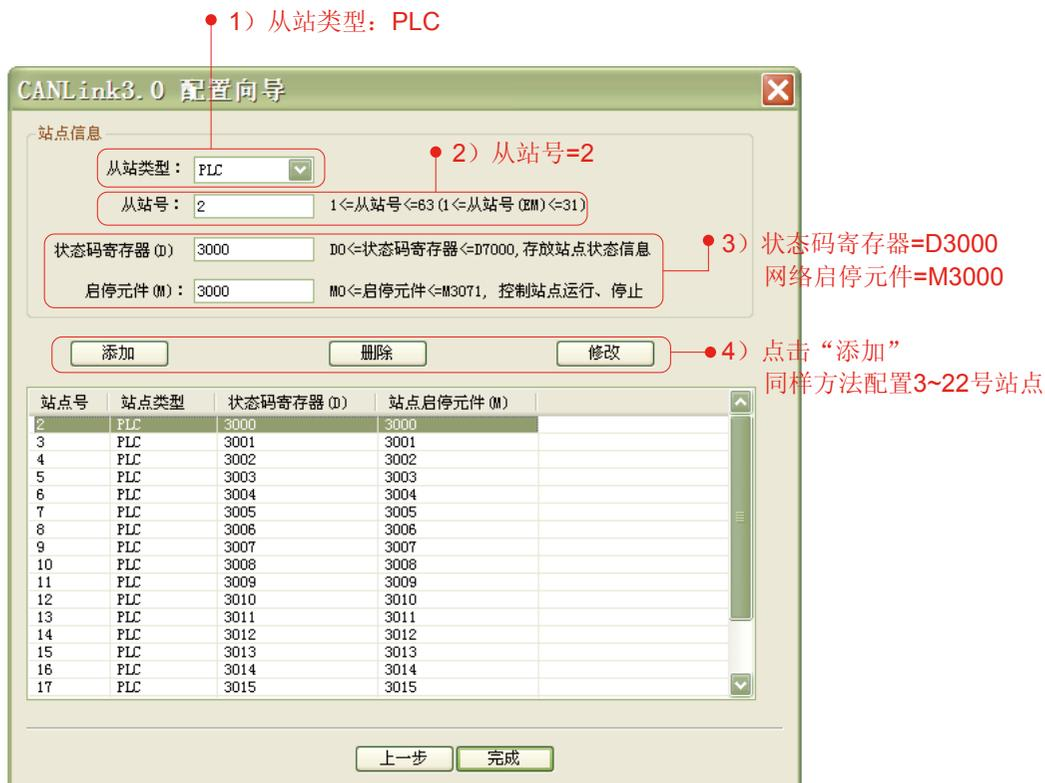
配置从站的参数有：站号 =2；网络启停 =M3000（控制该从站网络的通断，默认是网络打开）；状态码寄存器 =D3000（当前从站节点的状态）；然后点击“添加”。3#、4#……22# 同样设置方法。设置过程中可以删除和修改，但是不能修改“从站类型”。设置完成后，点击“完成”。
