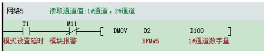
从站 CAN 发送配置表将 H2U-4ADR 模块 BFM#5(通道 1)、BFM#6(通道 2) 的值传送到 D2、D3 中，触发方式是时间，触发条件是 10ms，即每个 10ms 发送一次。
