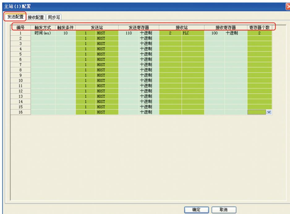
在“发送配置”菜单框下配置参数, 逐条配置触发方式、触发条件、发送站(默认值)、发送寄存器、
