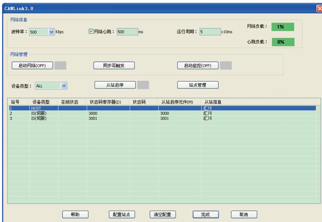
PLC 运行时，可以启动网络监控，查看“在线状态”、“网络负载”和“心跳负载”，网络负载必须控制在 75% 以内，心跳负载在 10% 以内。
