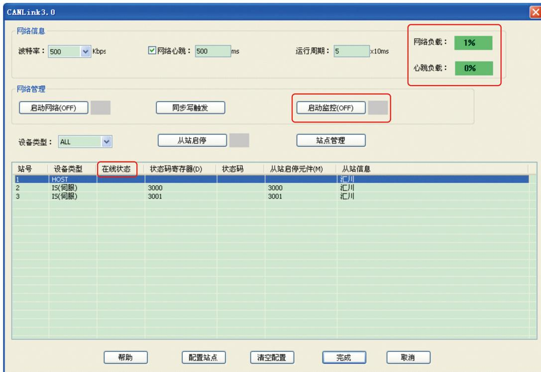
PLC 运行时，可以启动网络监控，查看“在线状态”、“网络负载”和“心跳负载”，网络负载必须控制在 75% 以内，心跳负载在 10% 以内。
