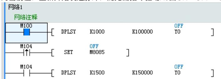
当M100启动, 正在发脉冲过程中(如上图), 启动M104, 则M100驱动的那一脉冲指令自动清除, 马上执行M104驱动的脉冲输出指令 (如下图), 不需等M100断开。
