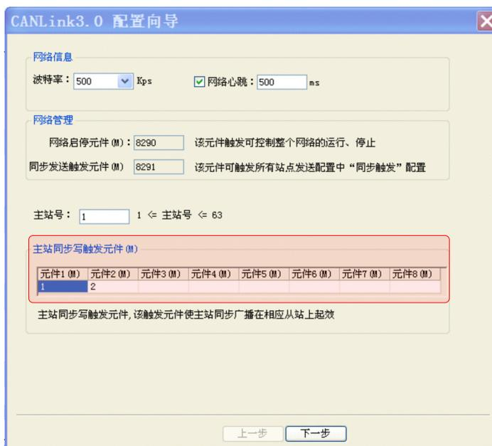
图 同步配置触发元件设置
