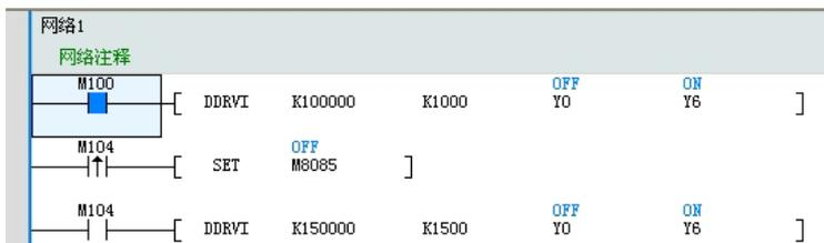
当M100启动, 正在发脉冲过程中(如上图), 启动M104, 则M100驱动的那一脉冲指令自动清除, 马上执行M104驱动的脉冲输出指令(如下图), 不需等M100断开。
