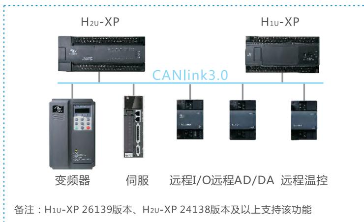
图 CAN-LINK 网络拓扑示意
