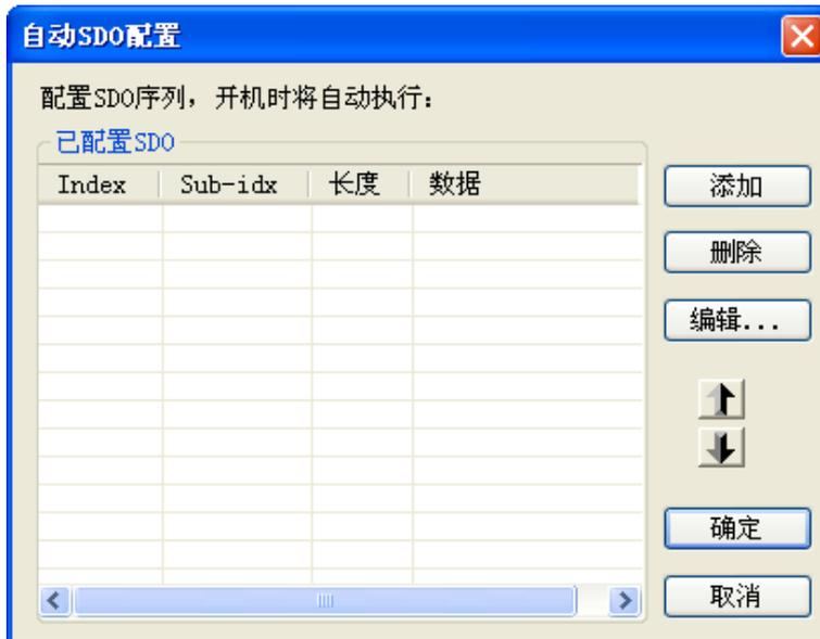
点击上图所示对话框中的『新增』按钮弹出下图所示的对话框，『index ( hex )』及『Sub-Index ( hex )』为欲访问参数的索引及子索引；『长度 ( dec )』由欲访问参数的数据类型决定，以字节为单位，用户可利用 index 字段旁的
