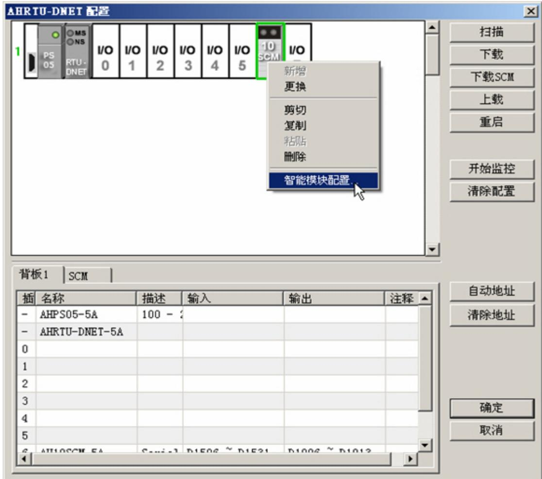
AH10SCM 智能模块配置界面会显示 AH10SCM 的基本信息，COM 口的通讯模式，寄存器映射范围和 AH10SCM 内部寄存器 I、O 的映射关系。在 COM Port 处右击，可以选择 COM Port 的通讯模式为 Modbus 模式或 UD Link 模式。
