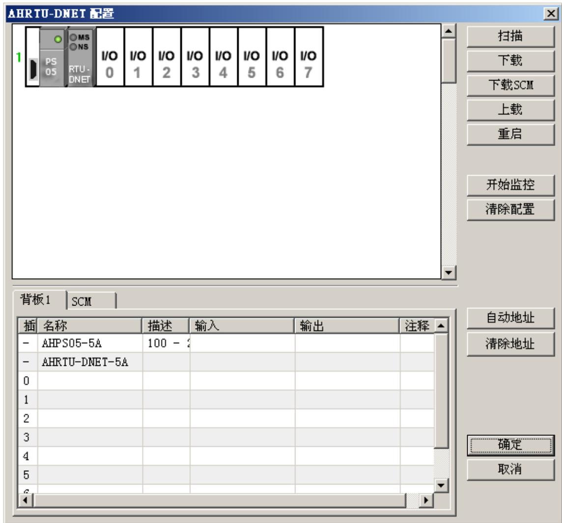
单击『扫描』按钮，将当前所有插在背板插槽上的 I/O 模块侦测显示出来，如下图：
