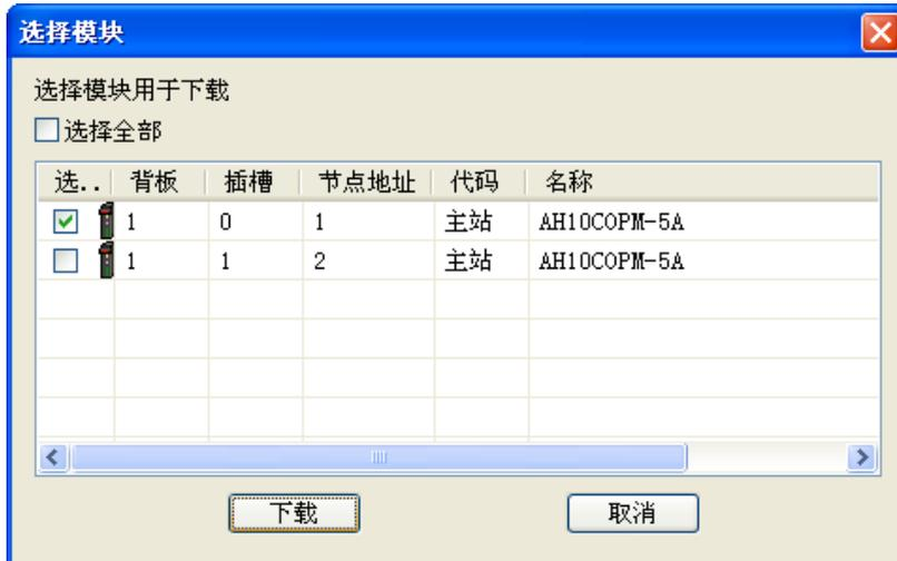
按下『下载』将配置数据下载到 AH10COPM-5A 模块。此时如果 PLC 处于运行状态，则会提示要先停止运行才可以下载，如下图所示。
