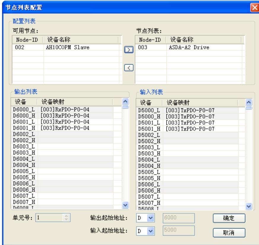
用同样的方法将从站 2 也加入节点列表。可以在下方的输入输出对应表中查看其 I/O 数据对应到 AH 系列 CPU 模块内的 D 寄存器地址。如下图所示。点击『确定』完成节点列表配置。
