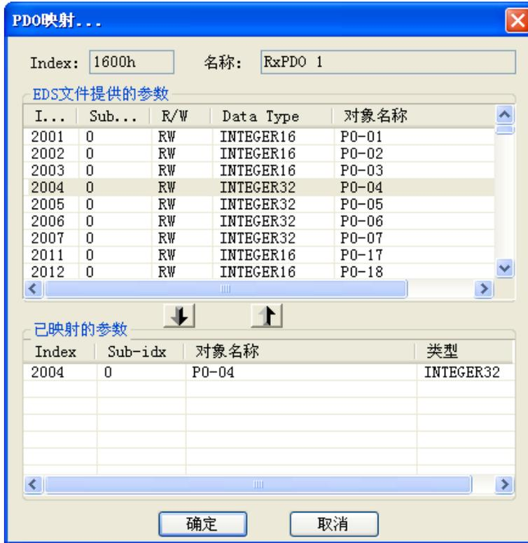
在『已经映射的参数』中，可以增加『EDS 文件提供的参数』中显示的参数。每个 PDO 中增加的参数的数据长度之和不能超过 8 个字节。配置完后，点击『确定』按钮。在『节点配置』接口中，当在已配置的 PDO 中选择相应的 TxPDO 或 RxPDO，点击『属性』选项，可以进入下图接口修改『COB-ID』及『传输类型』等信息。配置完后，点击『确定』按钮。点击『自定义 PDO』选项，可以自定义 RxPDO 或 TxPDO。
