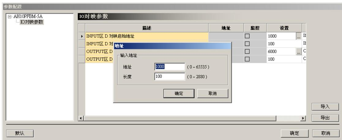
下图为 AHRTU-PFBS-5A 从站配置的 I/O 模块，及每个 I/O 模块对应的输入输出数据长度。
