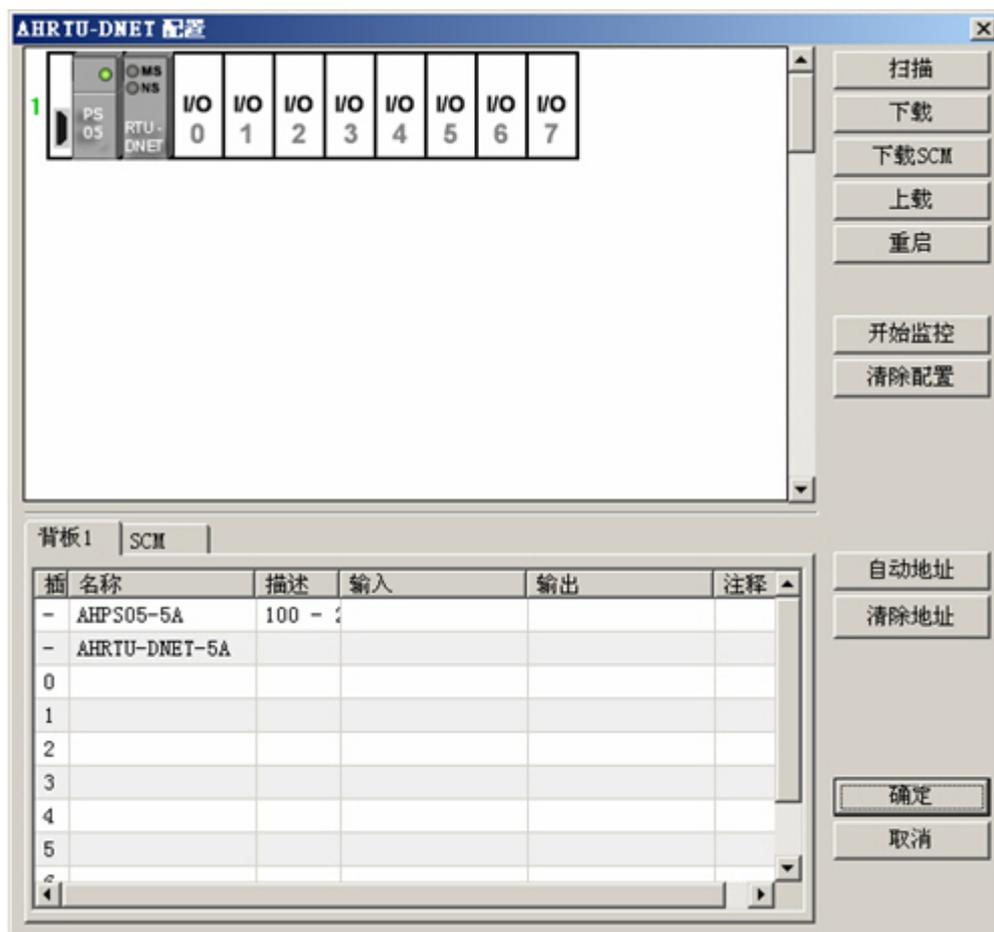
单击『扫描』按钮，将当前所有插在背板 I/O 插槽上的 AH10SCM 模块侦测显示出来，如下图：
