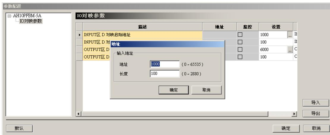
下图主要说明主站为从站配置模块参数分配的映射地址，通过上图和下图的配合，可以看出从站配置模块对应主站 PLC 的 OUTPUT 区 INPUT 区的 D 寄存器起始编号。
