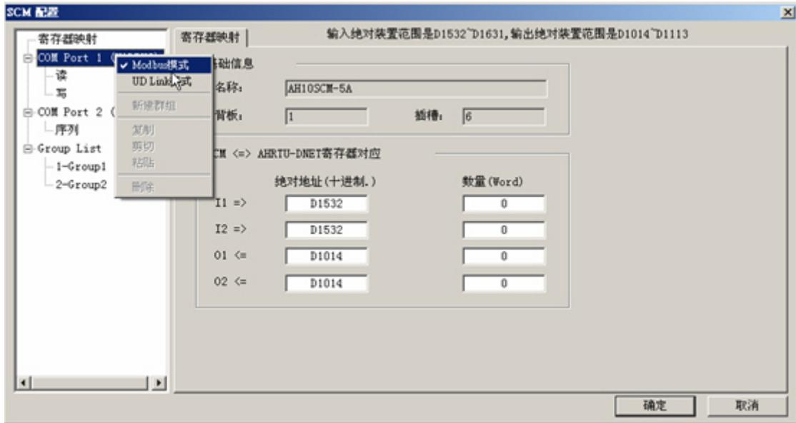
在 COM Port1 为 MODBUS 模式时，单击『读』或『写』，在右侧框图中单击鼠标右键点选“增加项目”来增加读/写的位与字的项目，上方为读/写位（bit）的项目，下方为读/写字（word）的项目。
