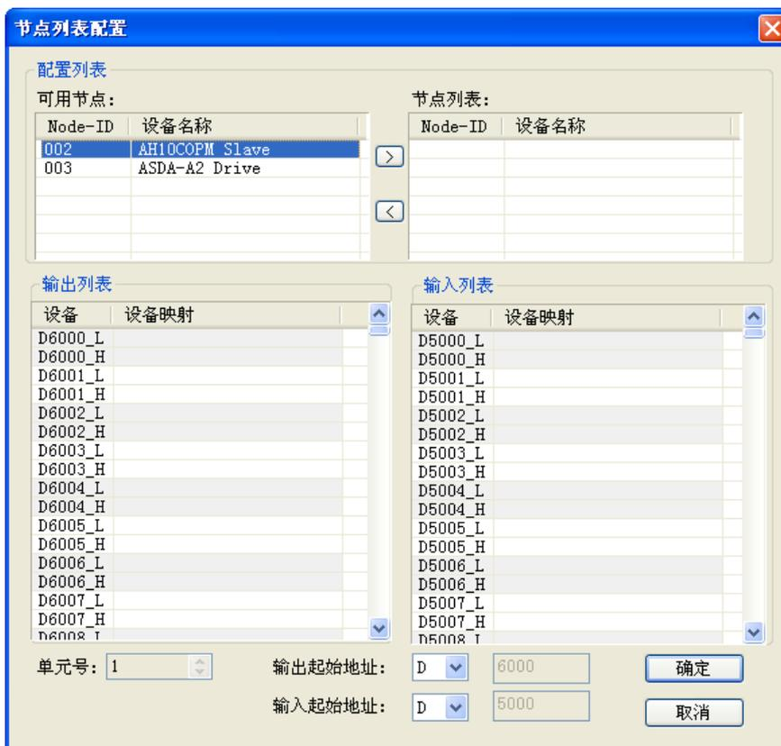
本例中先选中站地址为 3 的 ASDA-A2，点击按钮『>』，将从站 3 加入节点列表。此时选中节点列表中的从站 3，则可以在下方的输入输出对应表中看到从站 3 的 IO 数据对应到 AH 系列 CPU 模块内的 D 寄存器地址。如下图所示。
