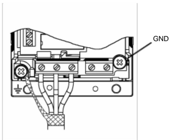
在浮地电网中不能使用 RFI 滤波器，电源可能通过滤波器电容和地短路，从而可能产生危险或导致损坏变频器。
