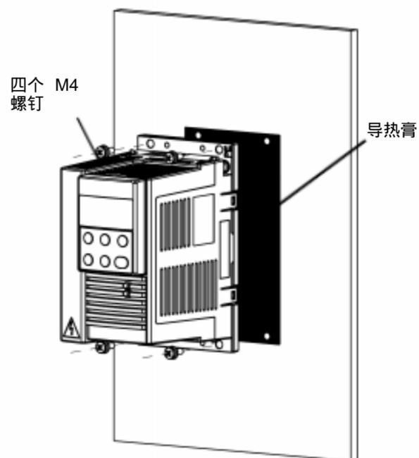
安装完毕后，通过监视 ACS100 的温度（参数 104），就可以检验散热效果，如果在最大环境温度下满负荷运行时，ACS100 的温度不超过  $85\text{ }^{\circ}\text{C}$ ，那么此散热器的设计是成功的。
