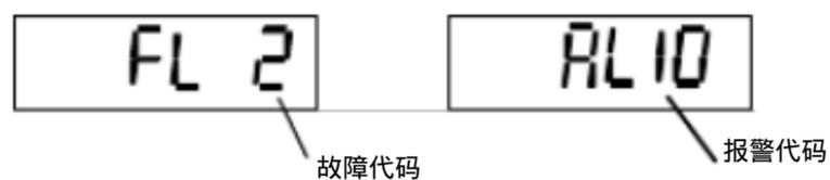
在故障诊断一节中 列出了所有的故障和报警代码。
