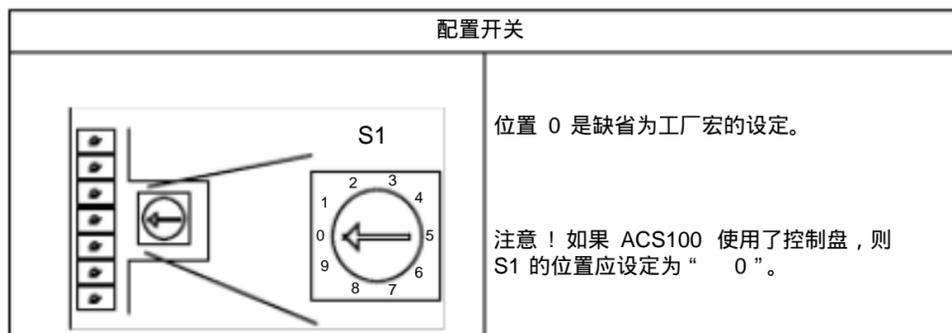
在设定 S1 时，首先设定的是电机额定频率  $f_N$ ，其次确定加 / 减速时间。
