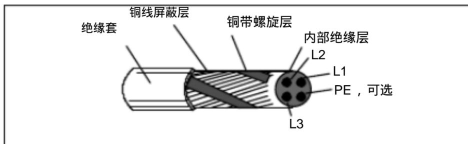
图 7 机电电缆屏蔽的最低要求（例如 MCMK, NK 电缆）
