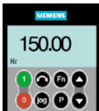
利用基本操作面板 ( BOP ) 可以改变变频器的各个参数， 为了利用 BOP 设定参数， 必须首先拆下 SDP， 并装上 BOP。 BOP 具有 7 段显示的五位数字， 可以显示参数的序号和数值， 报警和故障信息， 以及设定值和实际值。 参数的信息不能用 BOP 存储。
