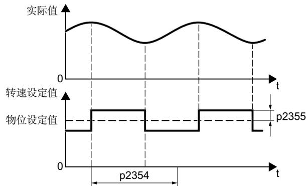
图 8-63 自动优化时的转速设定值和过程实际值示例
