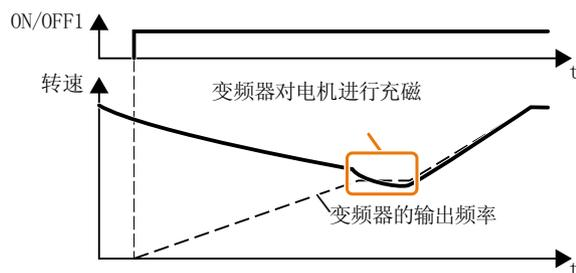
图 8-122 捕捉重启的基本工作方式
