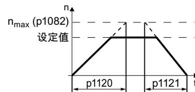
图 5-8 电机的斜坡上升和下降时间
