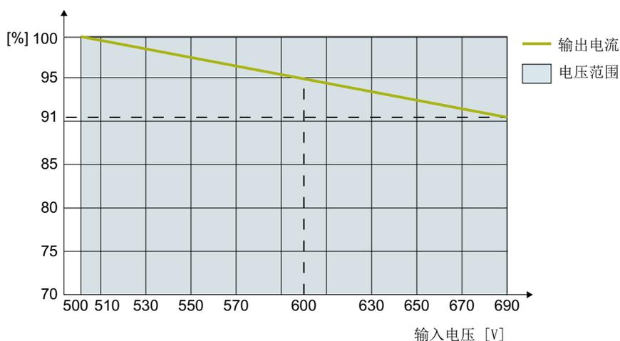
图 12-5 输入电压与电流降容的函数关系, FSH/FSJ
