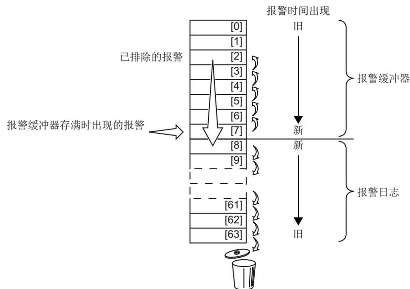
图 10-2 将已排除的报警转移到报警日志中
