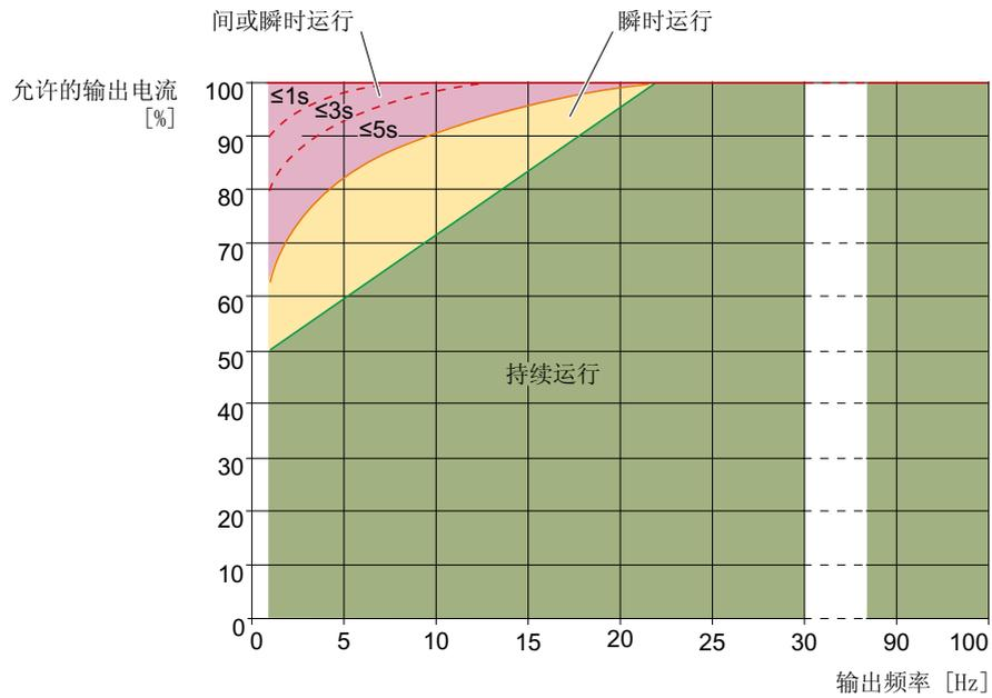
图 12-7 FSH/FSJ 的低频性能
