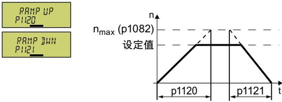
图 5-10 电机的斜坡上升和下降时间
