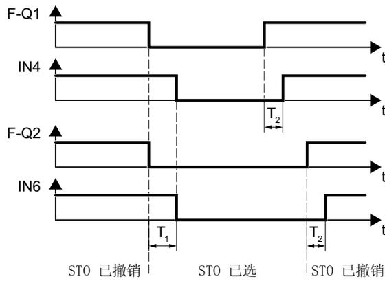
$T_1 \geq 30 \text{ ms}$                       当反馈出现偏差时，安全继电器须选择功能 STO，并报告故障。
