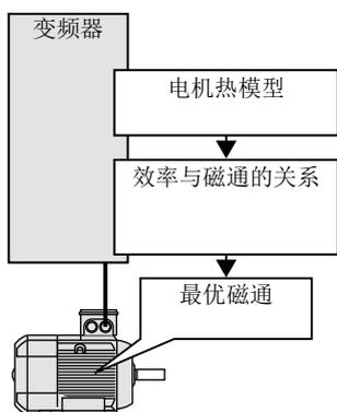
图 8-128 根据电机热模型计算最佳磁通
