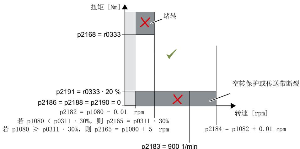
图 8-120 风机和压缩机应用的预设置
