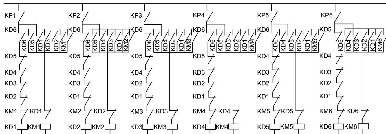
图 8-31 外部继电器控制电路
