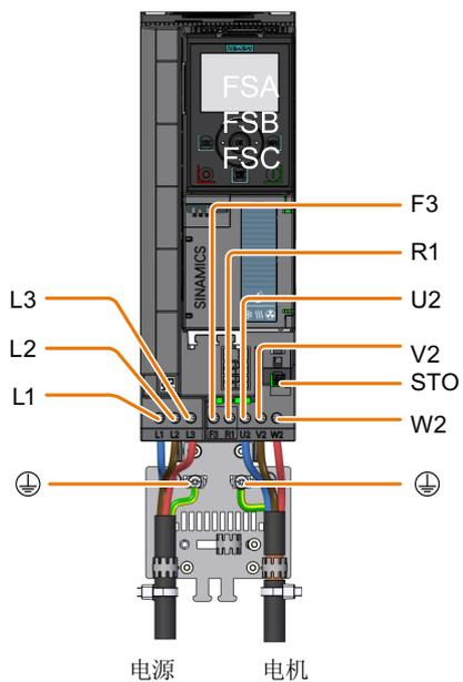
图 4-6 连接电源、电机和直流母线端子
