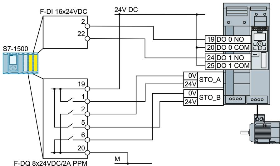
图 4-32 FSA ... FSG 上控制柜内部的 SIMATIC S7-1500 接线方式
