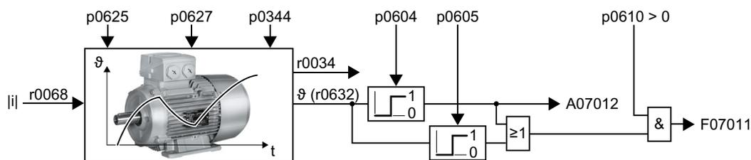
图 8-108 感应电机的热模型 2
