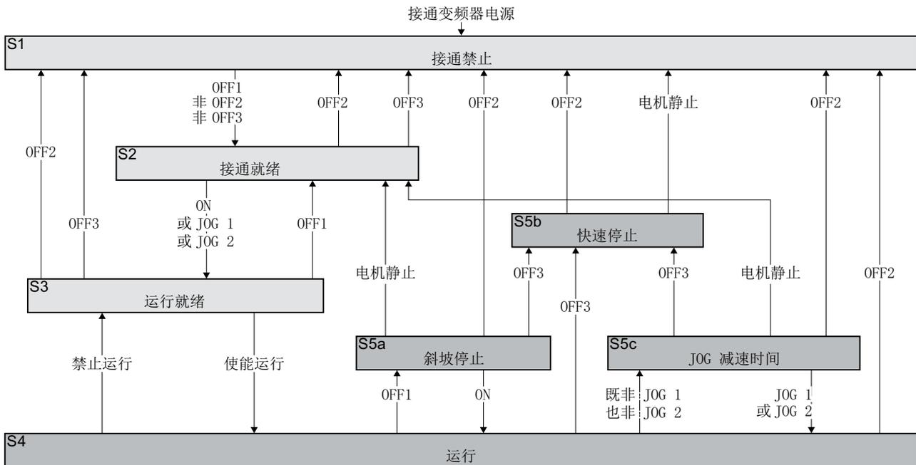
图 8-3 电机接通和关闭时变频器的顺序控制
