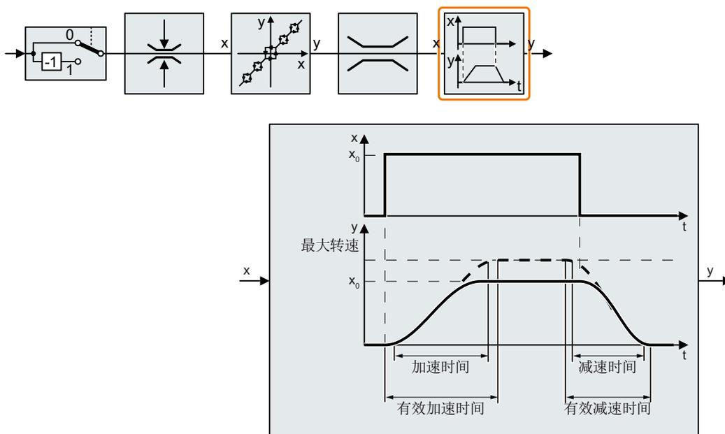
通过开始端圆整和结束端圆整可以实现平滑的加速和减速。
