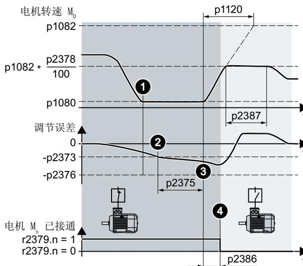
图 8-69 关闭非调速电机  $M_1 \dots M_2$
