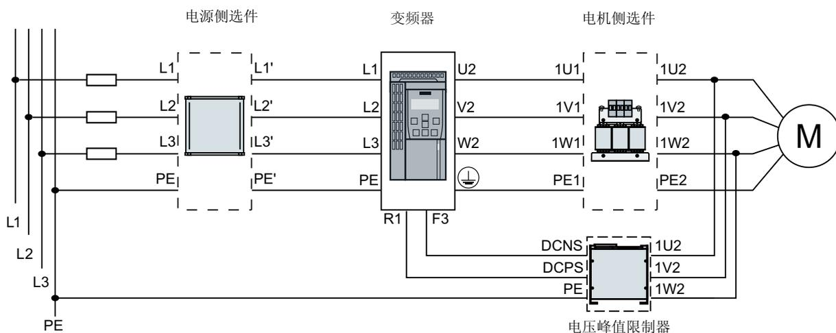
图 4-4 连接变频器 FSA ... FSG 及其选件
