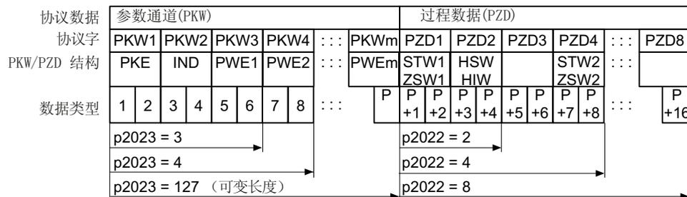
图 8-19 USS 报文有效载荷的结构
