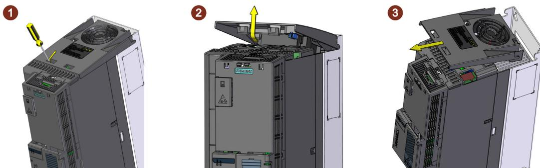
3. 按下图所示，以相反顺序安装新风扇单元。
