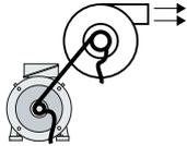
在带采用流体特性曲线的风机、泵或压缩机的应用中，转矩会按照某个特定的特性曲线跟随转速。在风机应用中，转矩过低表示从电机到负载装置的力传递中断。在泵应用中，转矩过低表示泵可能出现泄漏或空转。
