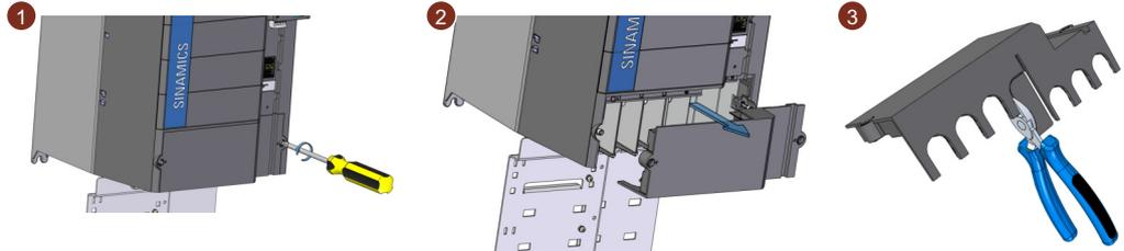
图 4-8 拆除连接盖板并开口，FSF/FSG
