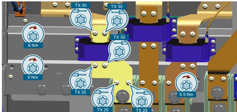
7. 拆下下方的铜排（TX-25）。
