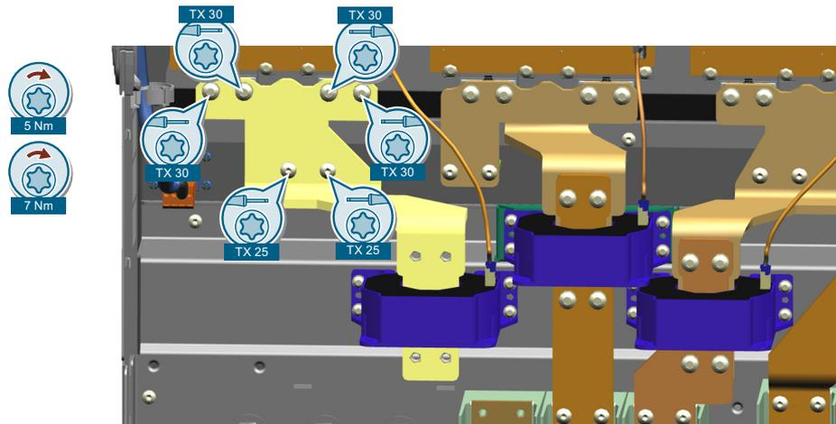
8. 拔出电流传感器的连接器。
