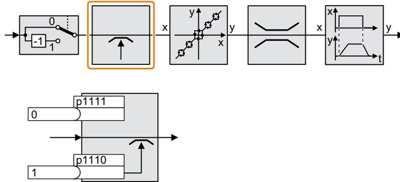
在变频器出厂设置中，电机的负旋转方向被禁止。
