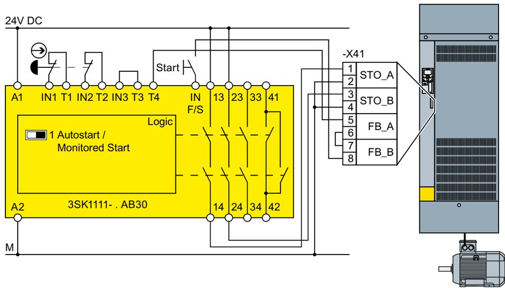
图 4-25 FSH、FSJ 上控制柜内部的 3SK1 接线方式
