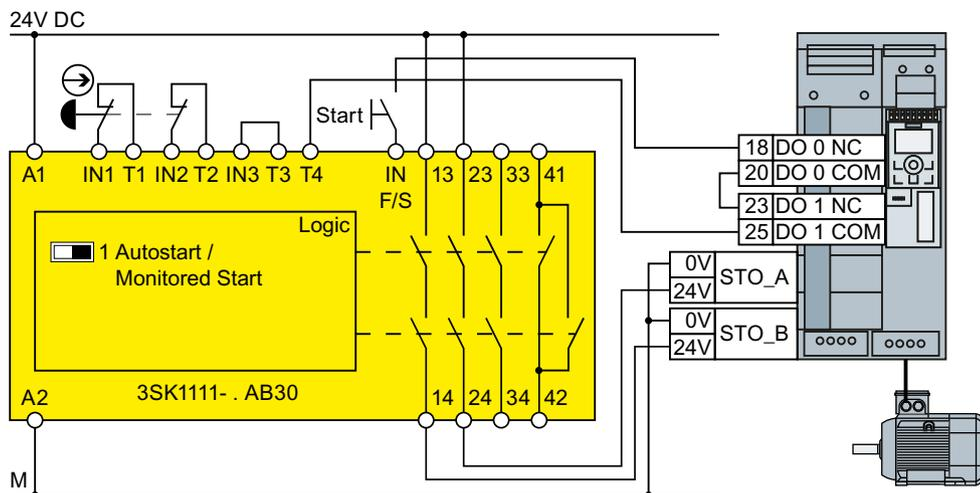
图 4-24 FSA ... FSG 上控制柜内部的 3SK1 接线方式
