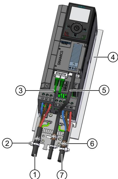
此处以变频器 FSB 屏蔽层的接地方式为例。
