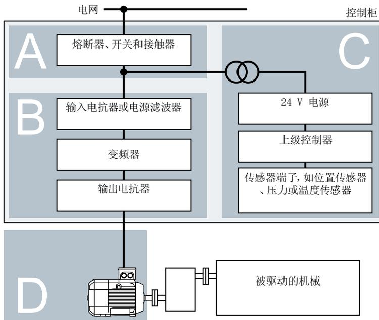
图 3-2 机器或设备的电磁兼容区域示例
