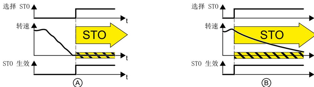
图 8-28 电机在静止 (A) 和旋转 (B) 时的 STO 功能
