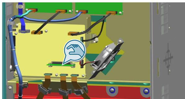
8. 松开 FPI 模块上的 6 个螺钉（TX-20）。
