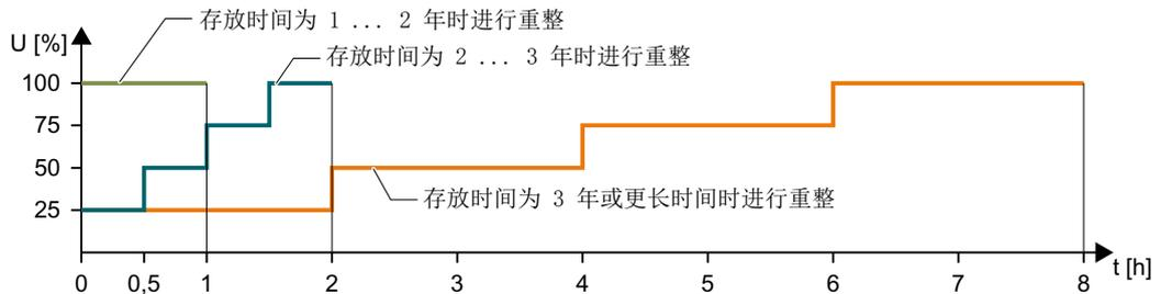
图 5-3 直流母线电容器重整
