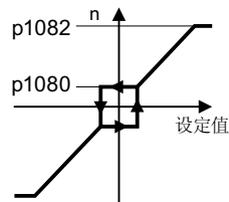
图 5-7 电机的最小转速和最大转速
