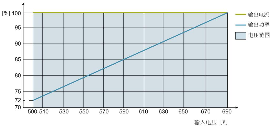
图 12-4 输入电压与电流降容的函数关系, FSA ... FSG
