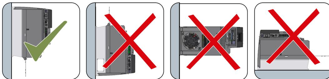
图 3-6 只有在垂直安装时才可使用下方的电源端子
