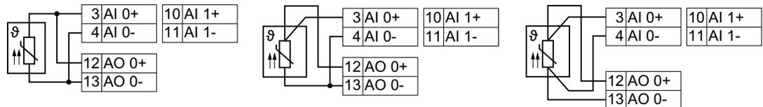
图 8-107 双线制连接、三线制连接和四线制连接
