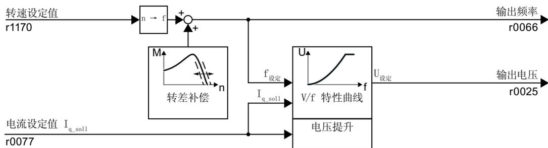
图 8-77 选择 Standard Drive Control 后的 V/f 控制的预设置
