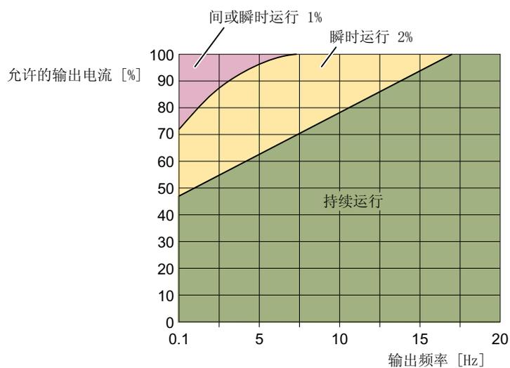
图 12-6 FSA ... FSG 的低频性能
