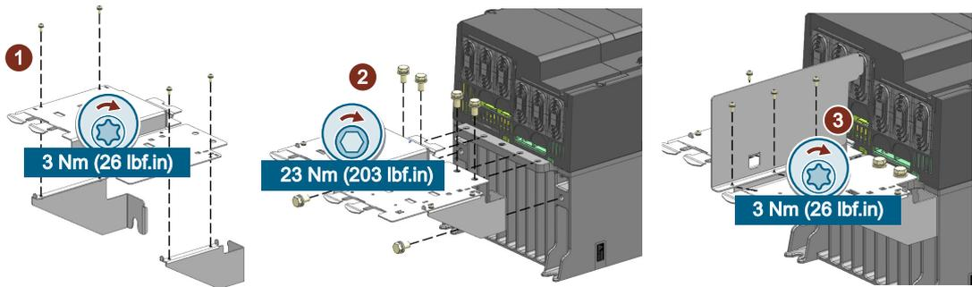
屏蔽连接件已安装完成。
