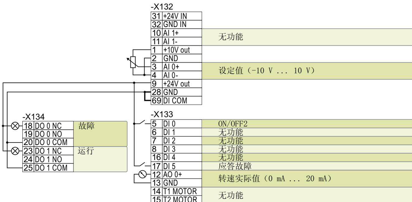
图 4-16 带 RS 485 接口的变频器的出厂设置:
