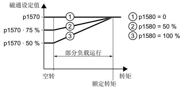
图 8-130 在额定负载以下运行时磁通设定值降低
