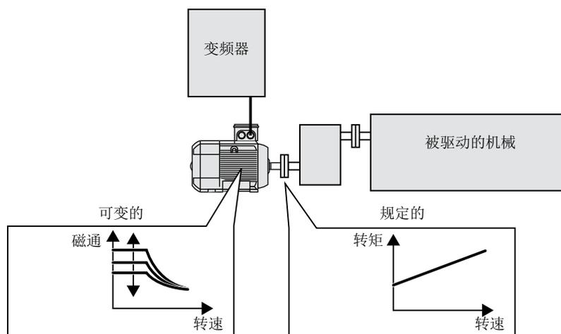
图 8-127 通过改变电机磁通实现效率优化
