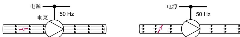
图 8-139 50 Hz 电源上使用泵和节流阀的流体控制
