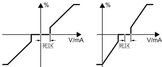
闭环控制使能后，如果转速设定值为 0，但电机却在某个方向上稍稍转动，这可能是因为信号电缆上存在电磁干扰导致。
