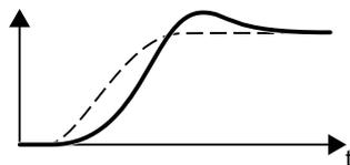
首先转速实际值延迟性跟随转速设定值，然后超过转速设定值。
