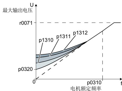
图 8-79 线性特性曲线上的升压降低示例
