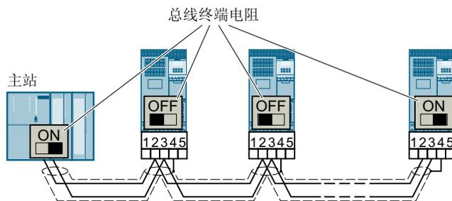
图 4-37 通过 RS485 接入现场总线
