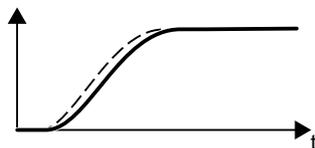
转速设定值（断线）随着设置的斜升时间和圆整而升高。
