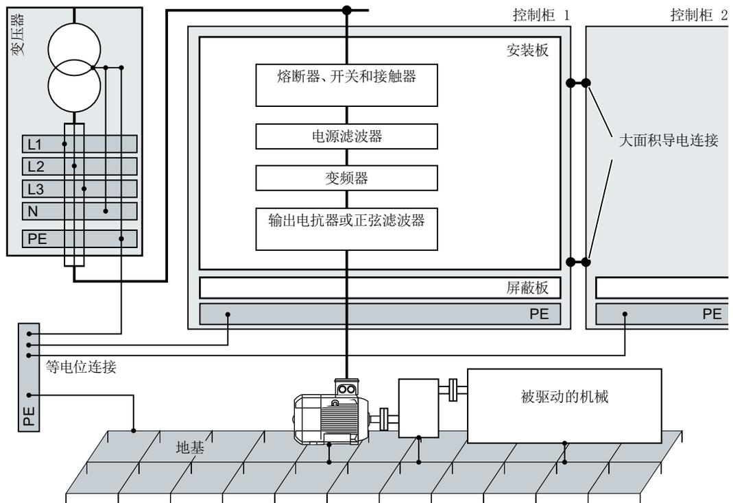
图 3-3 控制柜上和负载机械上需要实施的接地措施和高频等电位连接措施
