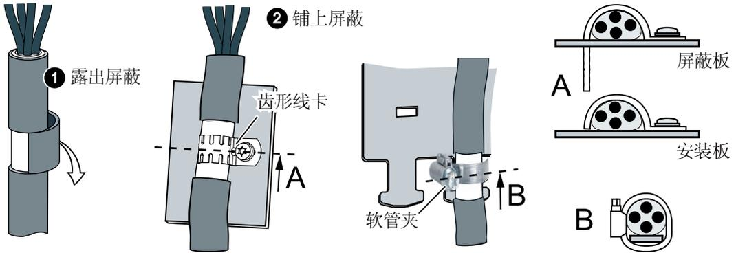
图 3-5 符合 EMC 规定的屏蔽层敷设示例
