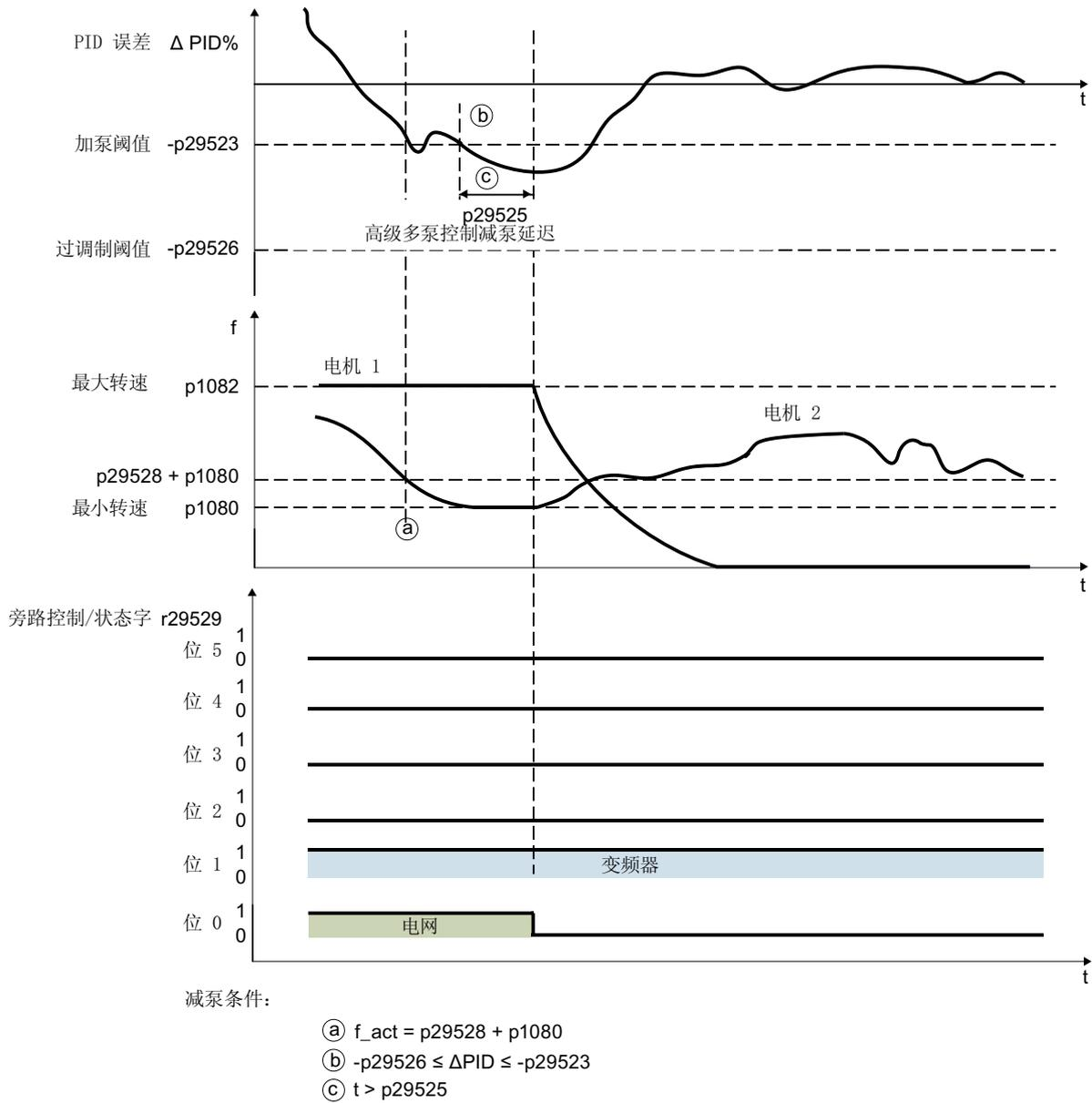
图 8-34 基于绝对运行时间减泵 (p29522 = 1)
