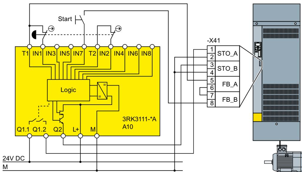
图 4-31 FSH 和 FSJ 上控制柜内部的 3RK3 接线方式
