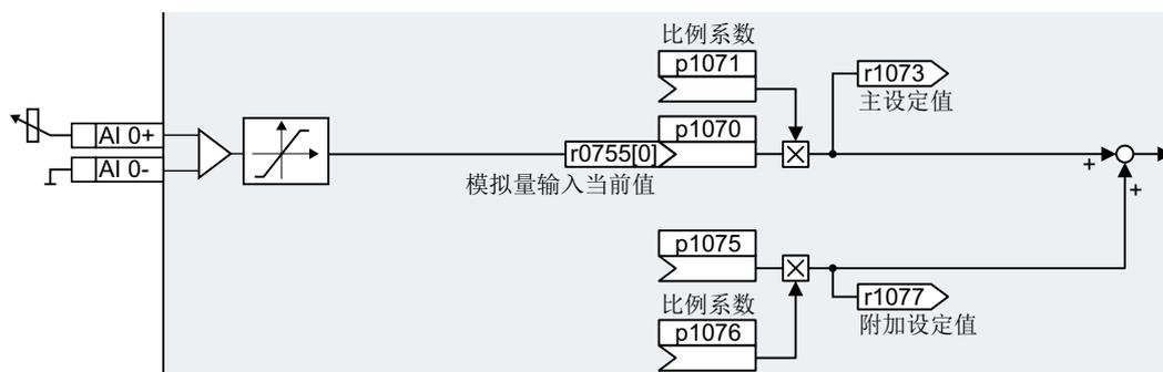
图 8-41 示例：模拟量输入 0 设为设定值源
