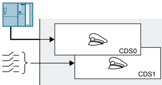
您可以设置不同方式的变频器控制，并在这些设置中进行切换。例如可按照上面的说明，可通过现场总线或通过其数字量输入操作变频器。
