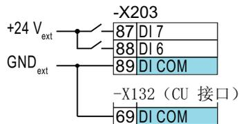
图 2-8 连接源型触点
