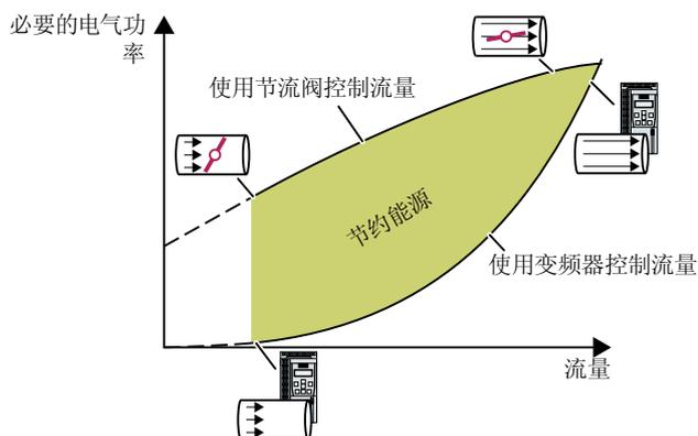
根据机械式流量控制的流体特性曲线以及测量出的功耗，变频器计算出节约的能耗。
