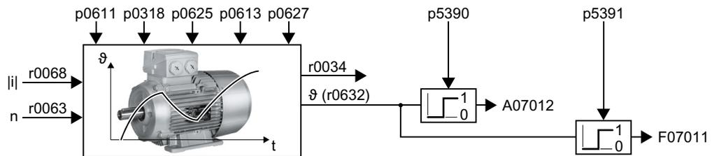
图 8-109 用于磁阻电机的电机热模型 1
