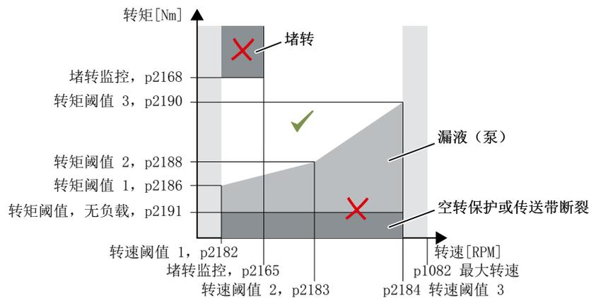
如果电机转矩和转速超出允许范围且超限现象超出时间 **p2192**，变频器会根据 **p2181** 中的设定作出响应。
