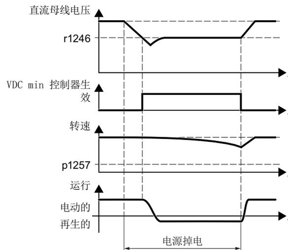
图 8-125 动能缓冲的工作原理
