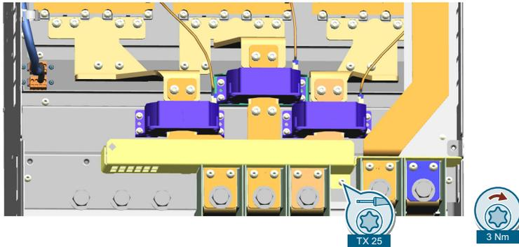
6. 拆下上方的铜排 (TX30 和 TX-25)。
