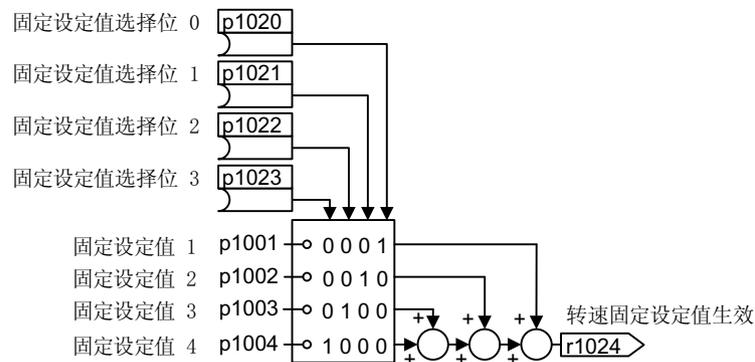
图 8-47 转速固定设定值的直接选择
