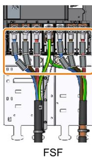
图 12-8 连接电缆上的铁氧体磁环
