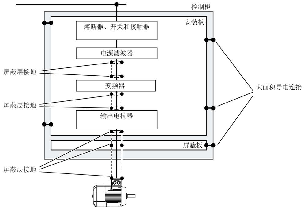
图 3-4 控制柜内部和外部的变频器布线
