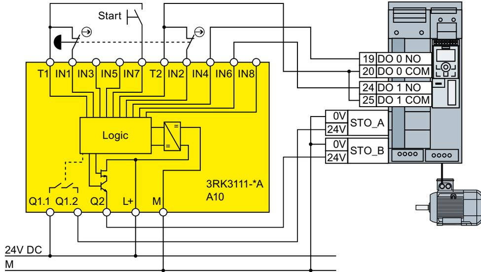
图 4-29 FSA ... FSG 上控制柜内部的 3RK3 接线方式
