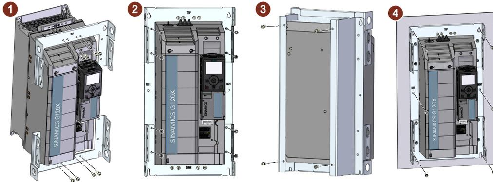
1. 在电柜壁上进行开口切割和钻孔。
