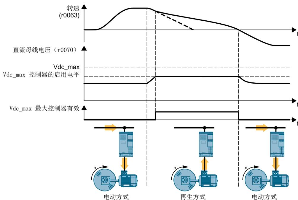
图 8-110 最大  $V_{dc}$  控制器的简化图
