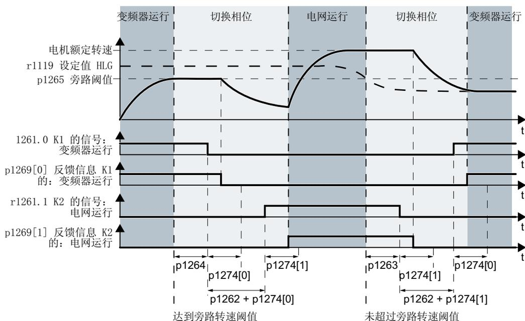
图 8-134 根据转速切换 (p1267.1 = 1)
