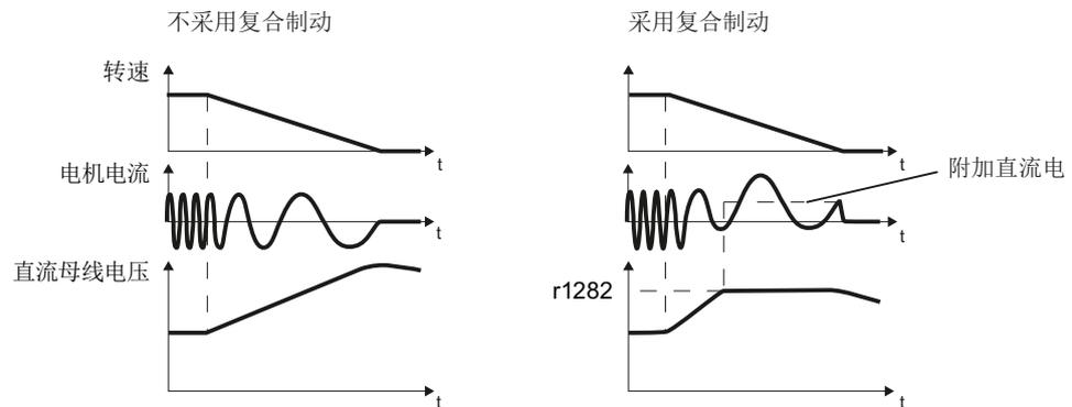
图 8-105 电机制动：无复合制动，有复合制动
