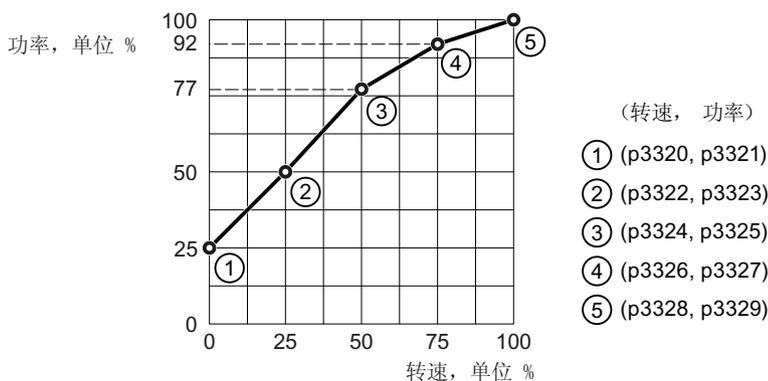
图 8-141 流体特性曲线的出厂设置
