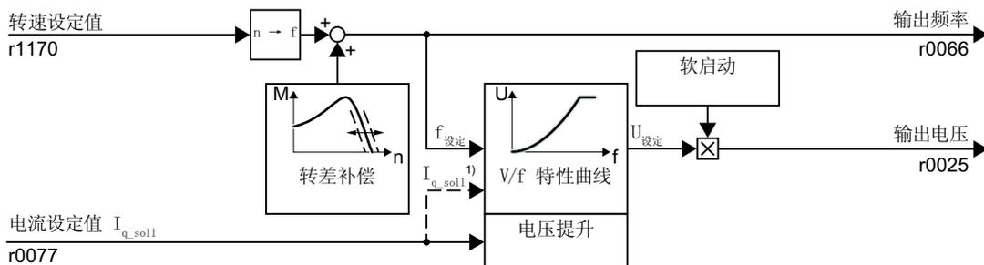
1) 在V/f控制方式“磁通电流控制（FCC）”中，电机低速时，变频器会调节电机电流（即起动电流）。
