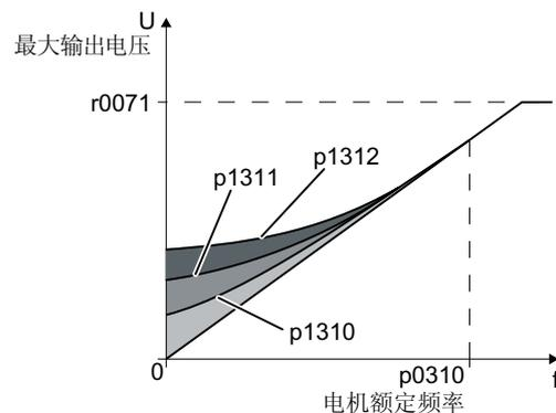
图 8-74 线性特性曲线上的升压降低示例
