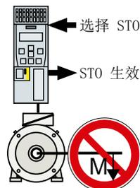
激活 STO 功能后，变频器阻断对电机供电。电机轴上无法再生成转矩。
