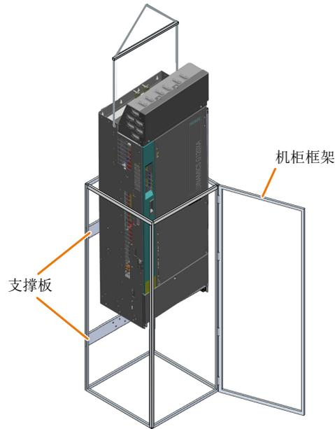
变频器安装完毕后，再次将两侧、背面和顶部的板材回机柜框架上。
