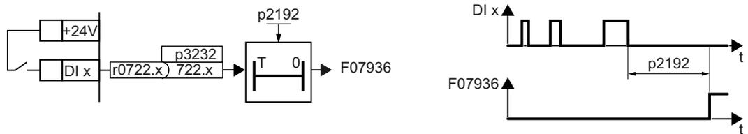
图 8-121 旋转监控的功能图和时序图
