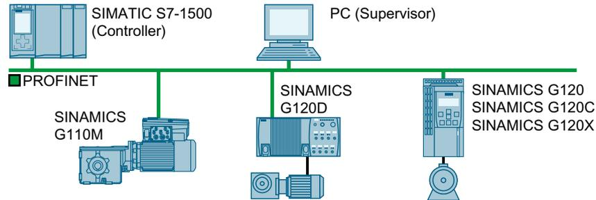
图 4-35 变频器在 PROFINET IO 模式中
