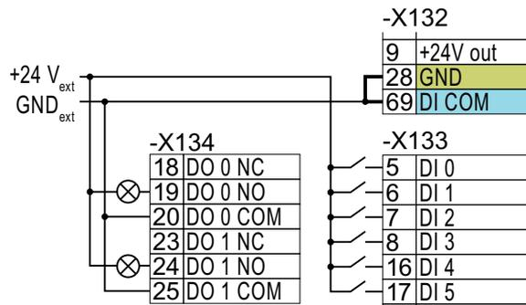
图 4-13 将源型触点连接到外部电源
