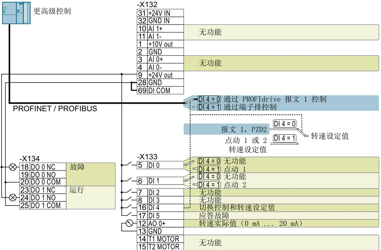
图 4-15 带 PROFINET 和 PROFIBUS 接口的变频器的出厂设置：
