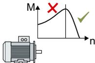
如果标准异步电机的负载超过了电机的倾覆力矩，电机在变频器上运行时也可能会失步。失步电机静止且不生成足够的转矩使负载装置加速。
