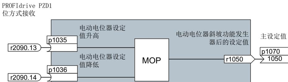
图 8-146 示例：数字量输入 0 上两个功能块的信号互联
