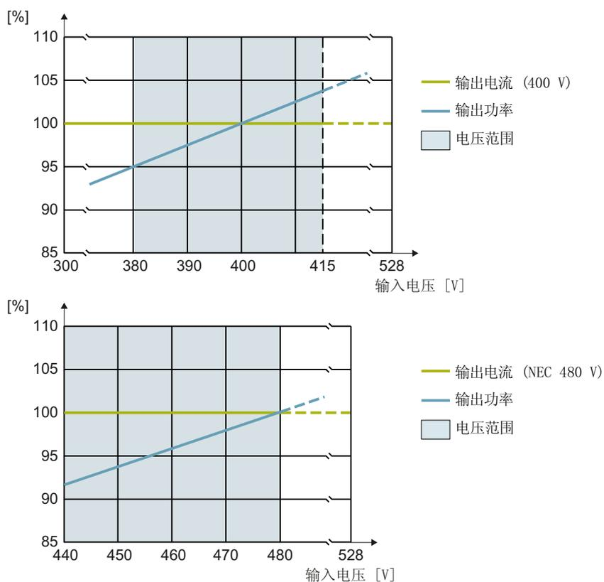
输入电压在 415 V 以及 480 V 以上时, 变频器的过热保护会导致电流或脉冲频率降低。
