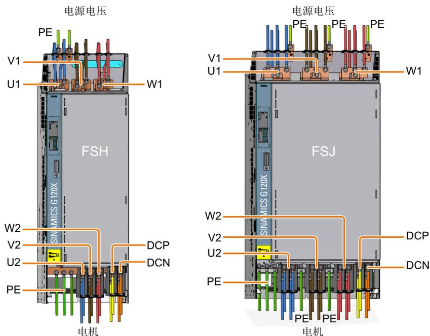
图 4-11 电源端子、电机端子和直流母线端子
