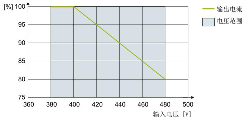
图 12-3 输入电压与电流降容的函数关系, FSH/FSJ
