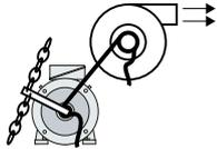
在带采用流体特性曲线的风机、泵或压缩机的应用中，转矩会按照某个特定的特性曲线跟随转速。在风机应用中，转矩过低表示从电机到负载装置的力传递中断。在泵应用中，转矩过低表示泵可能出现泄漏或空转。
