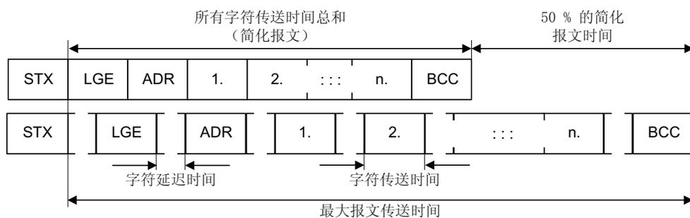
图 8-21 报文传送时间 = 所有字符传送时间总和 + 字符延迟时间
