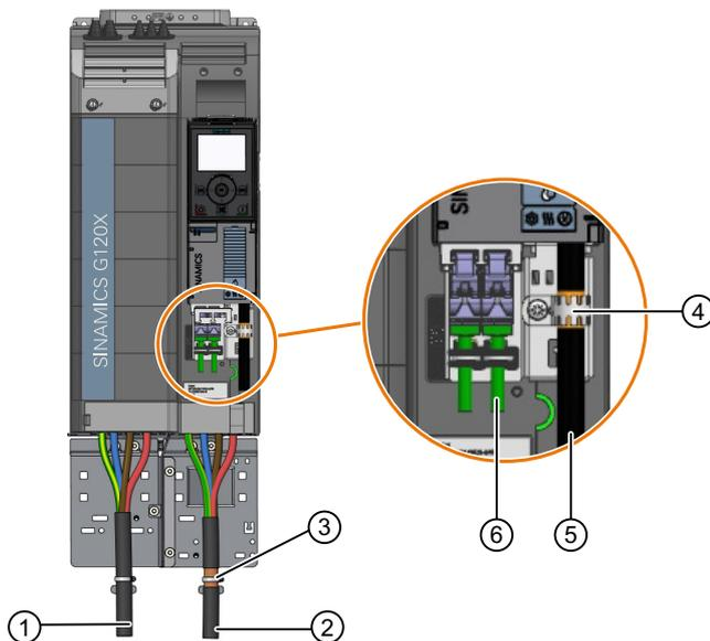
此处以变频器 FSD 屏蔽层的接地方式为例。
