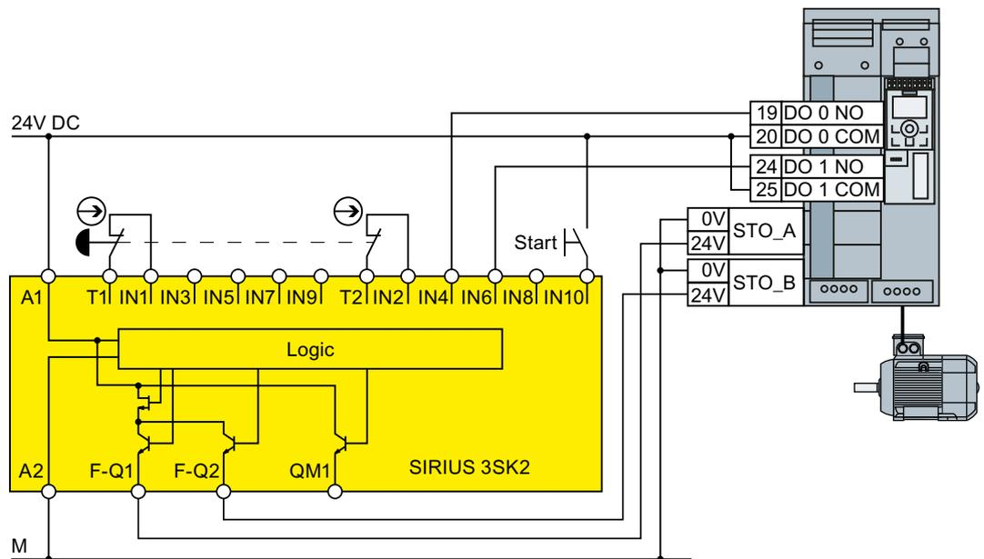
图 4-26 FSA ... FSG 上控制柜内部的 3SK2 接线方式
