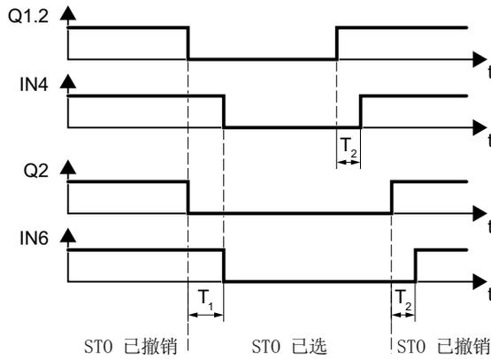
$T_1 \geq 30 \text{ ms}$                       当反馈出现偏差时，模块化的安全系统须选择功能 STO，并报告故障。
