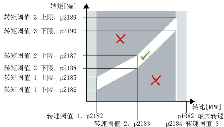
如果电机转矩超出允许范围且超限现象超出时间 p2192，变频器会根据 p2181 中的设定作出响应。
