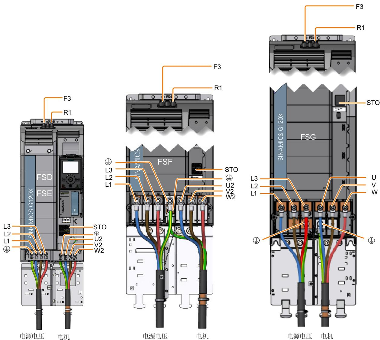
图 4-9 连接电源和电机
