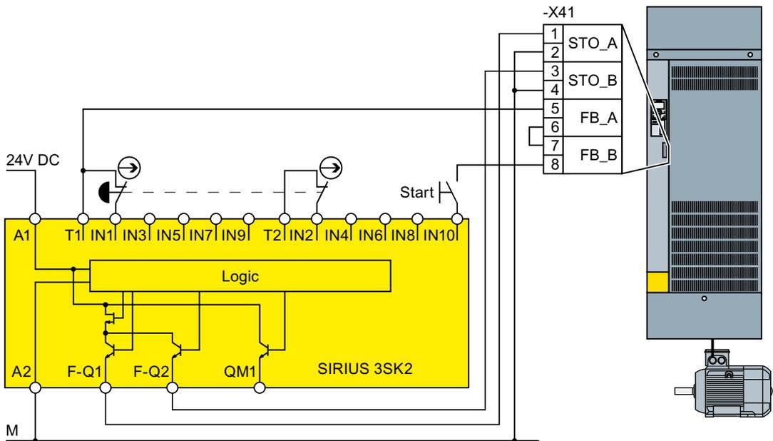
图 4-28 FSH 和 FSJ 上控制柜内部的 3SK2 接线方式
