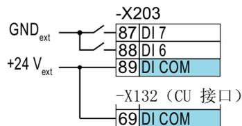
图 2-9 连接漏型触点
