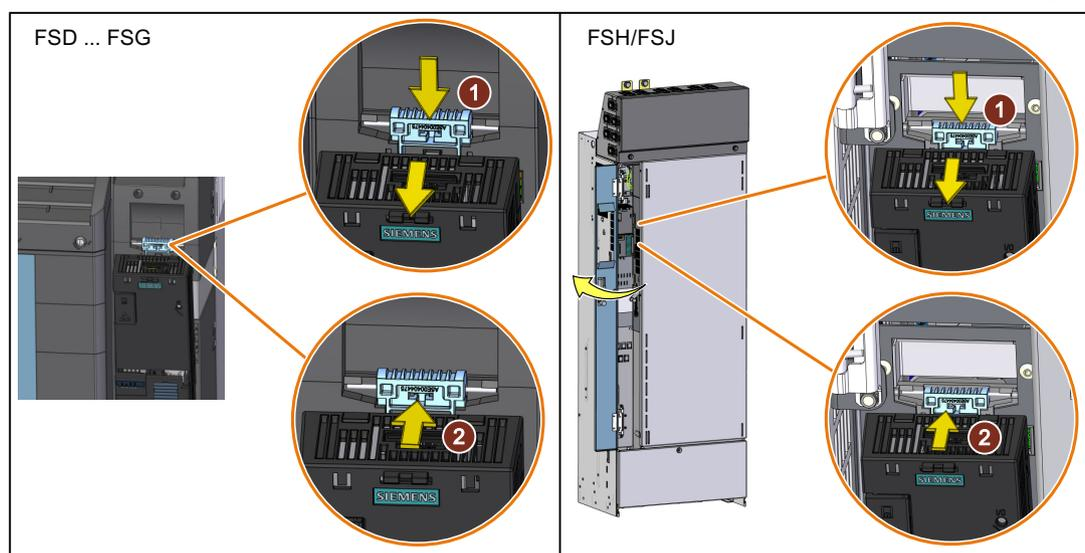
6. 将控制电缆连接至新的控制单元。
