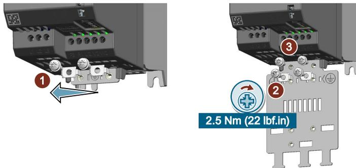
屏蔽连接件已安装完成。
