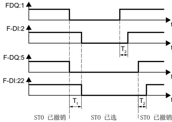
$T_1 \geq 30 \text{ ms}$  当反馈出现偏差时，SIMATIC 须选择功能 STO，并报告故障。
