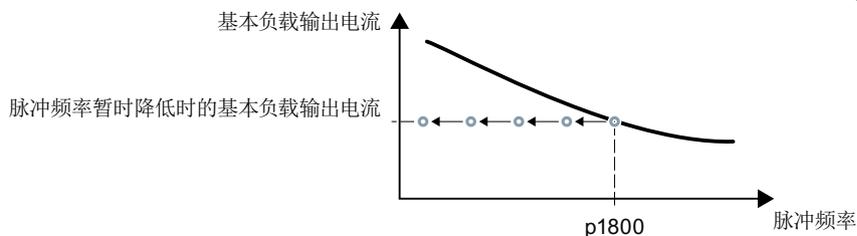
图 8-106 过载时的降容特性曲线和基本负载输出电流
