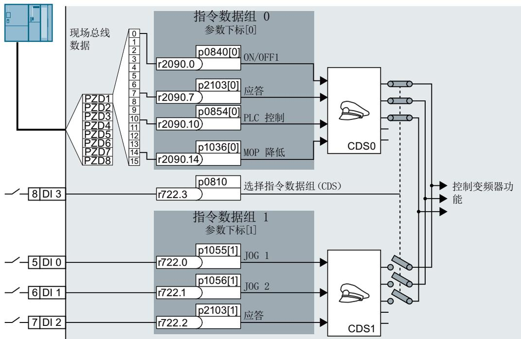
变频器根据数字量输入 DI 3 来分析控制指令：
