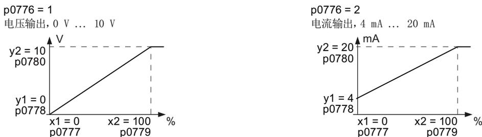
参数 p0777 ... p0780 的一个下标分别对应了一个模拟量输出，例如：参数 p0777[0] ... p0770[0] 属于模拟量输出 0。
