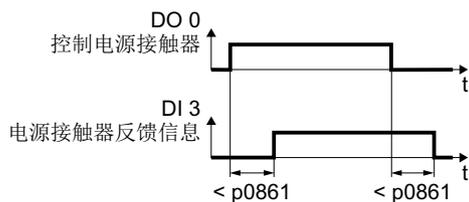
图 8-138 通过 DO 2 的电源接触器控制，带通过 DI 3 的反馈信息
