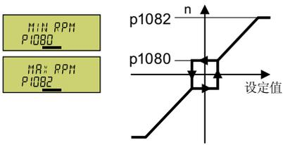
图 5-9 电机的最小转速和最大转速
