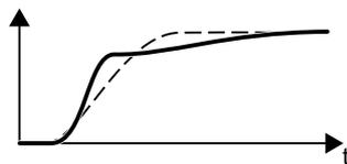
首先转速实际值上升的比转速设定值快。在设定值达到最终值之前，设定值超过实际值。然后实际值接近设定值，无超调。
