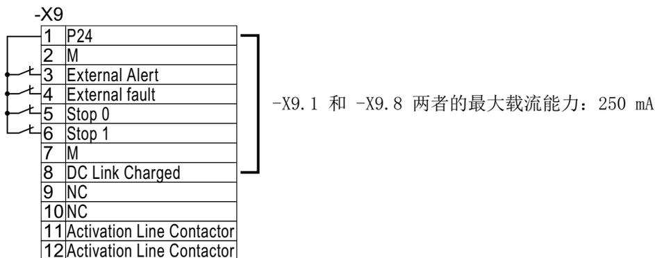
图 4-19 端子排 X9, 提供内部 24 V 电源
