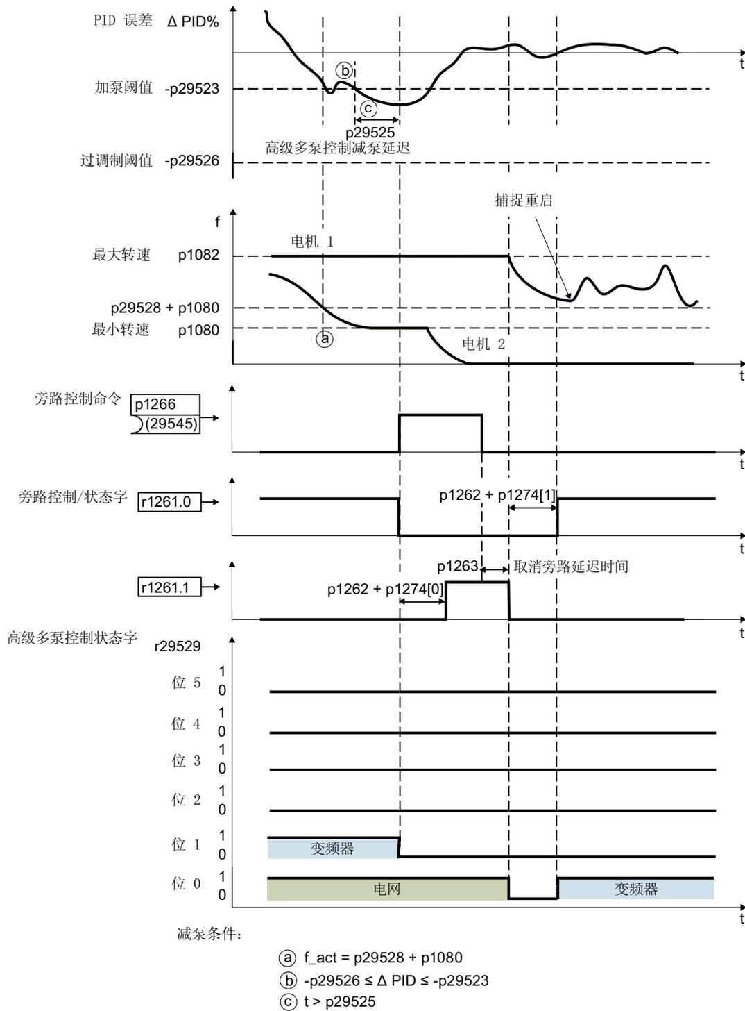
图 8-33 基于固定顺序减泵 ( $p29522 = 0$ )
