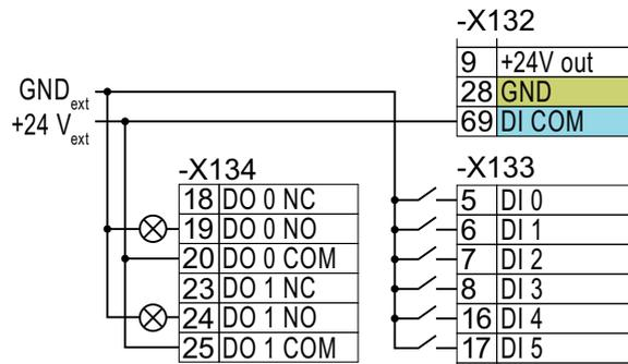
图 4-14 将漏型触点连接到外部电源
