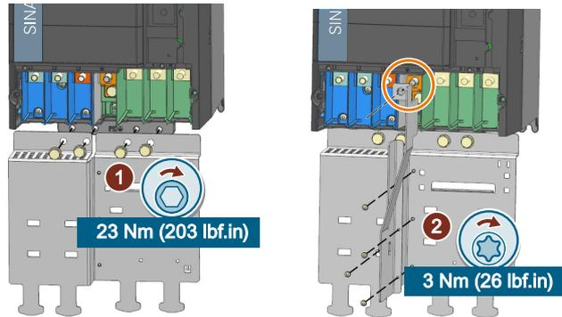
屏蔽连接件已安装完成。
