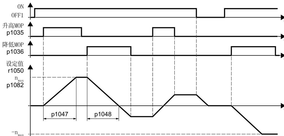
图 8-44 电动电位器的功能图
