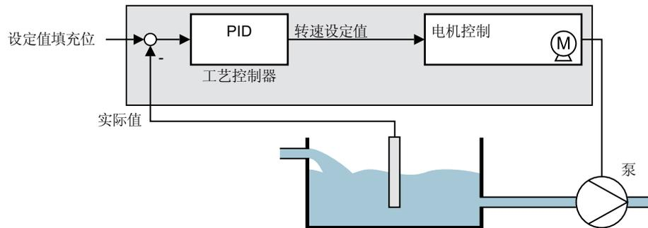
图 8-56 示例：工艺控制器用作流量控制器
