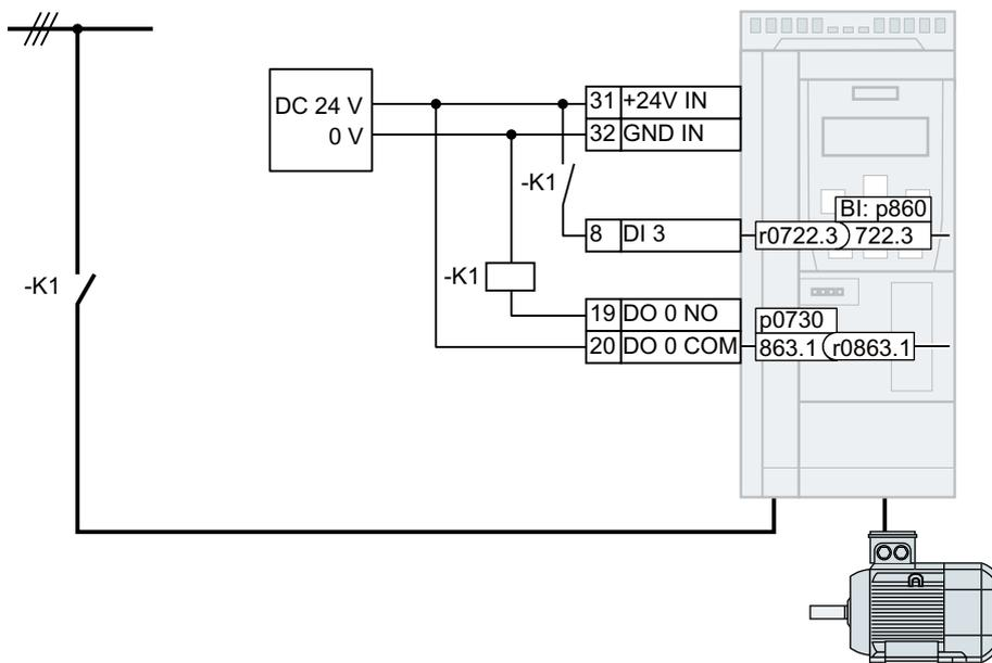
图 8-137 通过 DO 0 的电源接触器控制，带通过 DI 3 的反馈信息
