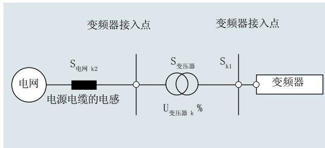
在此情况下，变频器连接点处的进线短路功率  $S_{k1}$  约为：
