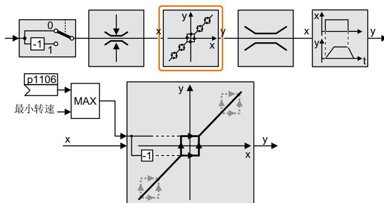
只有在电机的加速或减速过程中，变频器才允许电机转速（绝对值）短时间低于最小转速。
