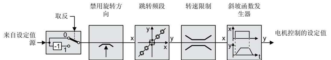
图 8-51 变频器内的设定值处理
