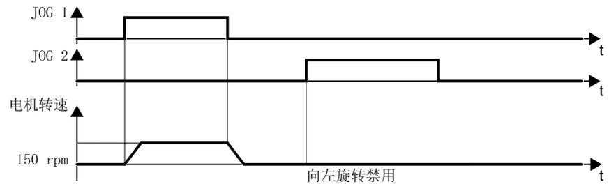
图 5-5 出厂设置中的电机点动模式
