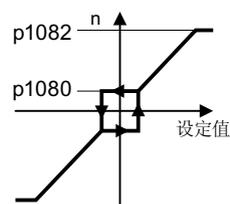
图 5-11 电机的最小转速和最大转速
