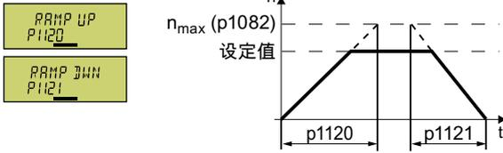
图 5-12 电机的斜坡上升和下降时间
