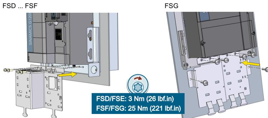
3. 若变频器带内置电源滤波器, 需额外安装 EMC 连接板 (包含在变频器的供货范围内)。有关安装 EMC 连接板的详细信息, 参见以下章节:
