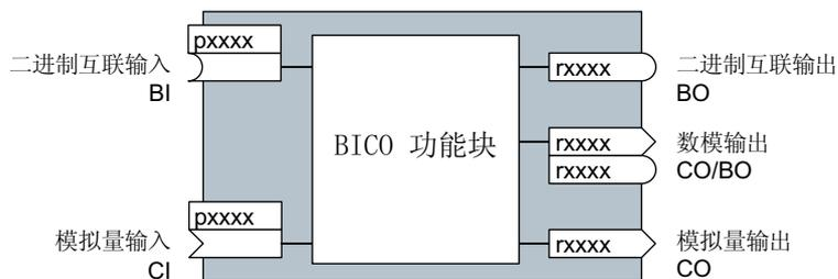
图 8-147 二进制输入/输出和模拟量输入/输出的符号
