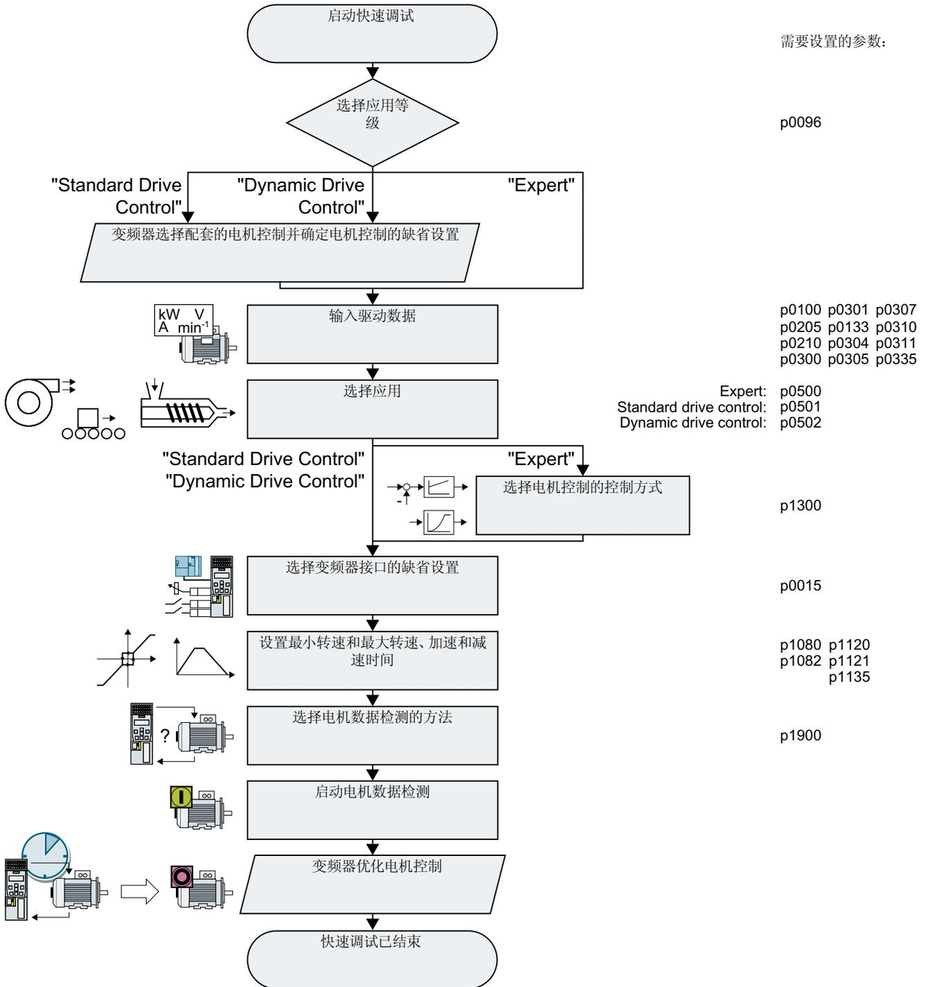
图 5-6 使用操作面板 BOP-2 进行快速调试
