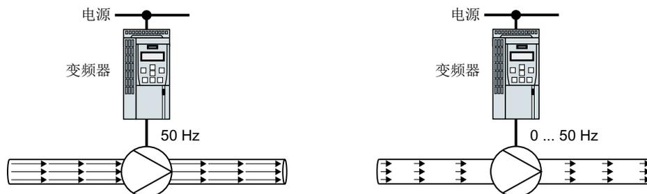
图 8-140 使用泵和变频器的流体控制
