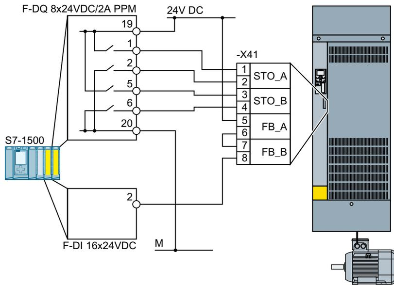
图 4-34 FSH 和 FSJ 上控制柜内部的 SIMATIC S7-1500 接线方式
