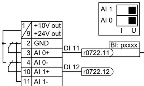
为了将模拟量输入用作附加的数字量输入，必须将相应的状态参数 r0722.11 和 r0722.12 的其中一个与选中的 BI 连接在一起。
