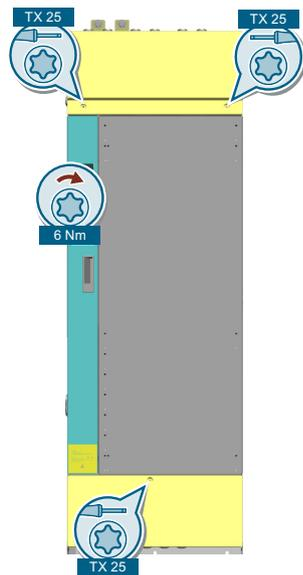
图 4-10 拆下前盖板
