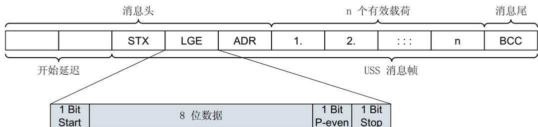
图 8-18 USS 报文的结构
