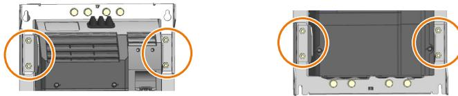
4. 使用四个螺钉将安装框架固定在变频器的安装孔处（FSD: 4 × M5 - 6 Nm; FSE: 4 × M6 - 10 Nm; FSF: 4 × M8 - 25 Nm; FSG: 4 × M10 - 50 Nm）（步骤 ③）。
