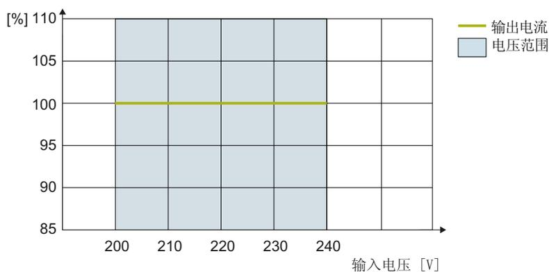
图 12-1 输入电压与电流降容的函数关系, FSA ... FSF
