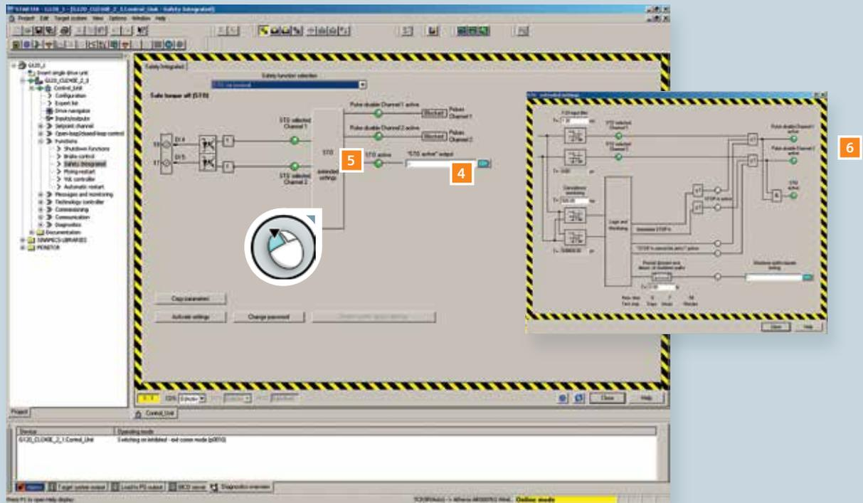
现在已设置第一个安全通道。对于第二个通道，仅需复制参数。点击“Activate settings”结束安全组态设置。在工作台区域点击“Alarms”，并按“Acknowledge”按钮激活实际的安全功能。
