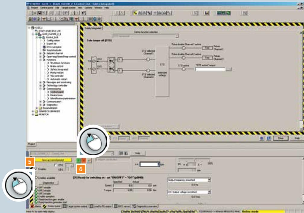
电机数据识别处理完成。7991 报警消失时，表示已经成功完成参数设置。
