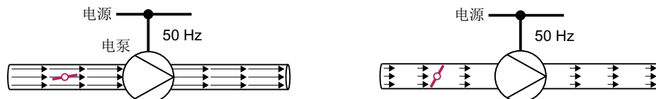
图 6-75 50 Hz 电源上使用泵和节流阀的流体控制
