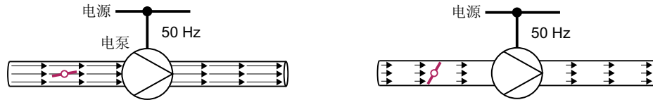
图 6-82 50 Hz 电源上使用泵和节流阀的流体控制
