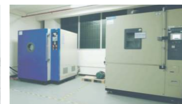
低气压测试箱（左）， 恒温恒湿测试箱（右）
