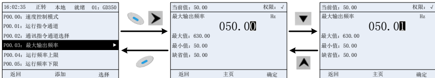
图 5.16 参数设定编辑界面示意图
