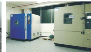
低气压测试箱（左）， 恒温恒湿测试箱（右）
