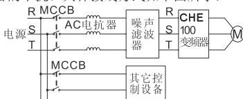
图 4-20 主回路电源侧连接图
