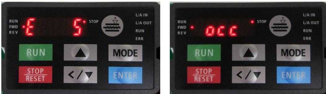
KPVJ-LE02 数字操作面板显示之异常讯息，左图为数字码显示方式，右图为数字码所对应的英文显示码显示方式。两者会自动切换显示。
