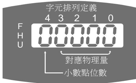
范例：若使用者想用转速（rpm）的方式来设定电机的转速时，若电机为 4 极 60Hz 则所对应的物理量为 1800，所以此参数可设定为 01800，表示 60Hz 对应 1800rpm 无小数点。若要显示 rps 则可设定为 10300，表示 60Hz 对应 30.0 小数点 1 位。
