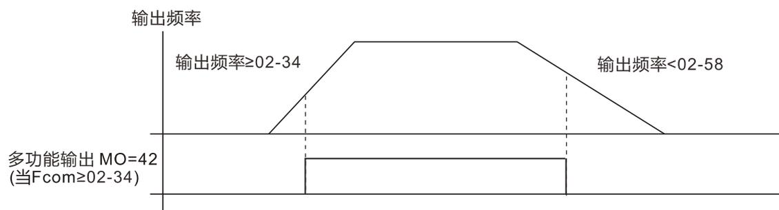
建议搭配齿隙加减速中断使用，如下图所示：
