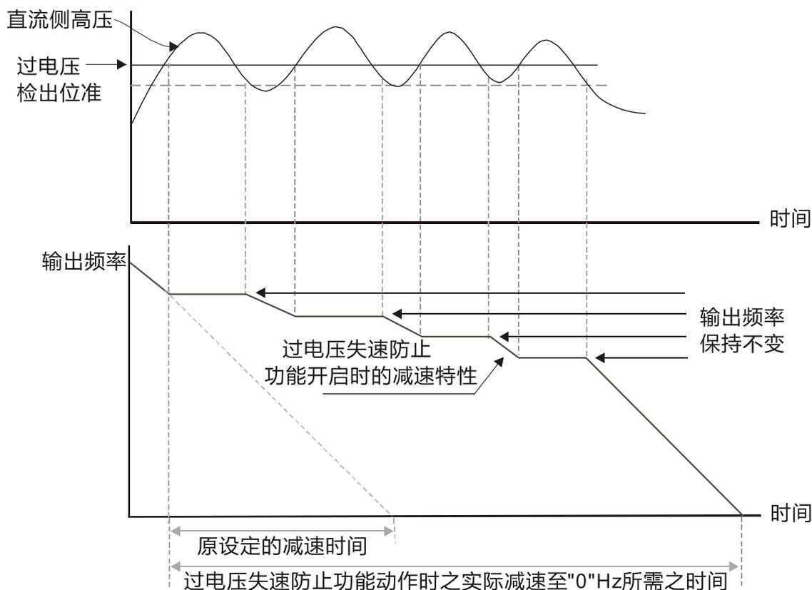
☞ 设定值为 1 时，使用智能型过电压失速防止在减速过程中，会维持 DC BUS 电压使变频器不会发生 OV 动作。
