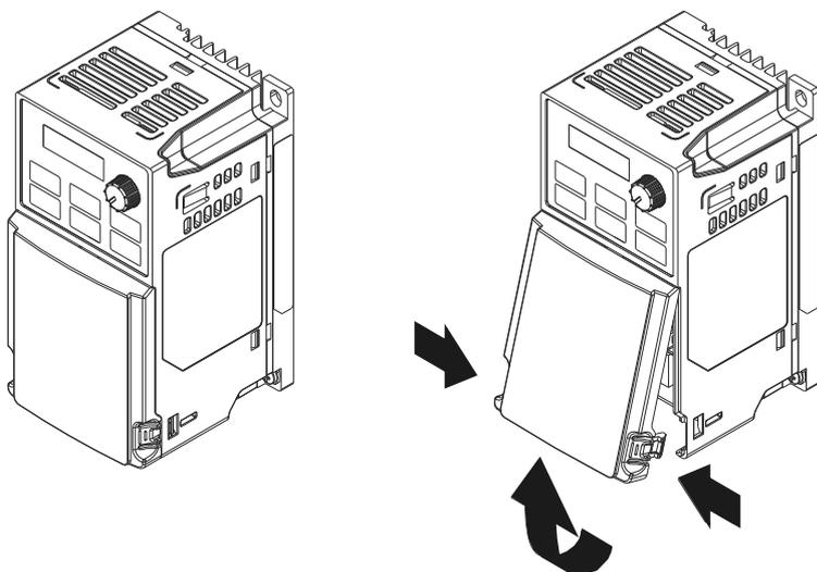
按压两侧卡勾，将前盖旋转取出
