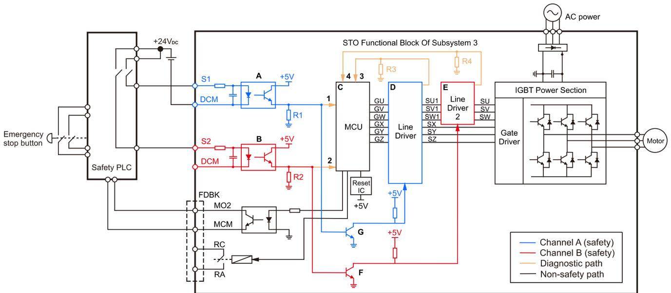
图 15-1、安全转矩停止功能之电路方块图
