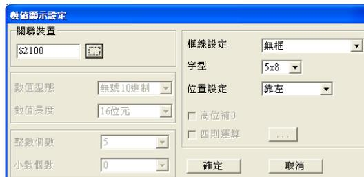
**关联装置**可以选择想要读取的 VFD 通讯位置，如想读取输出频率(H)，设定\$2202。（其余数值请参照 ACMD ModBus Comm Address List 文件）。
