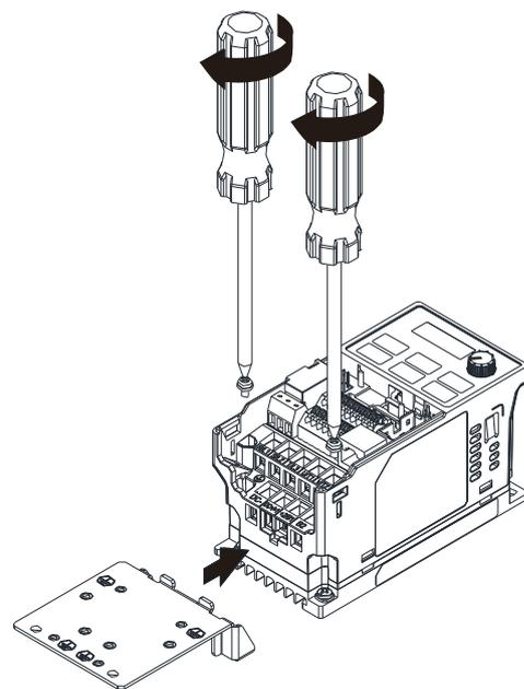
2. 依使用线径选用适合之 R 型夹后，固定 R 型夹于铁板上。
