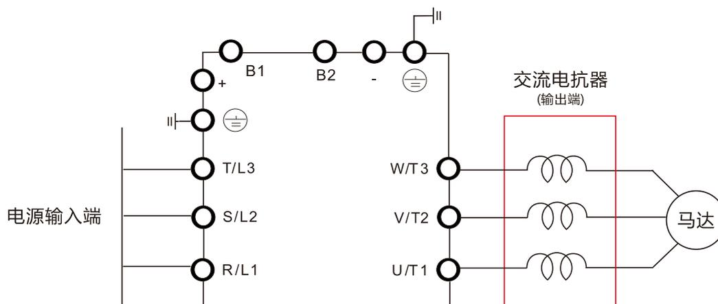
输出电抗器安装示意图
