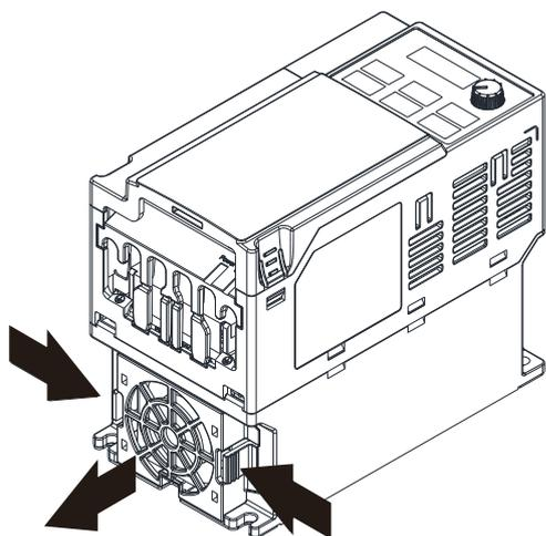
2. 风扇取出时，同时须将风扇的电源线拆除。
