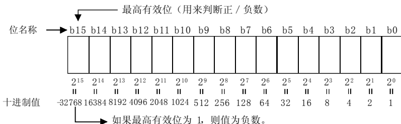
图 3.9 内置 PLC 功能中每个寄存器的数值表示
