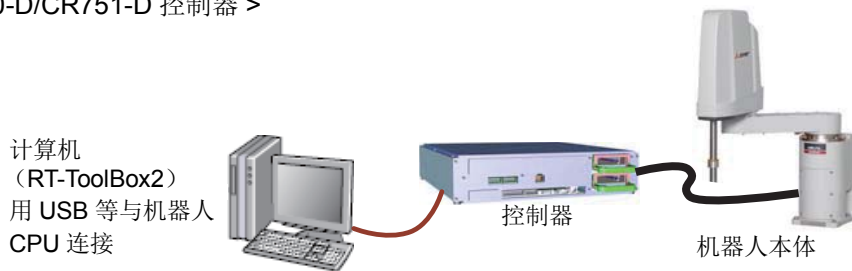
图 5-16: 设备的连接（CR750-D/CR751-D 控制器）
