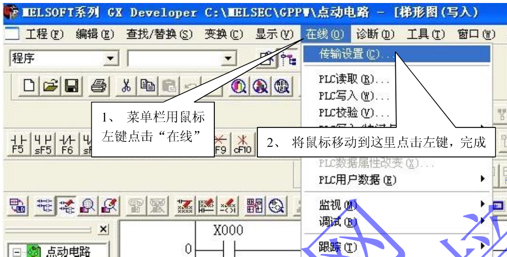
图 4-24 设置 PLC 与计算机连接 COM 口
