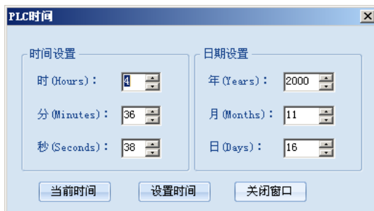
图2-21 设置 PLC 时间
