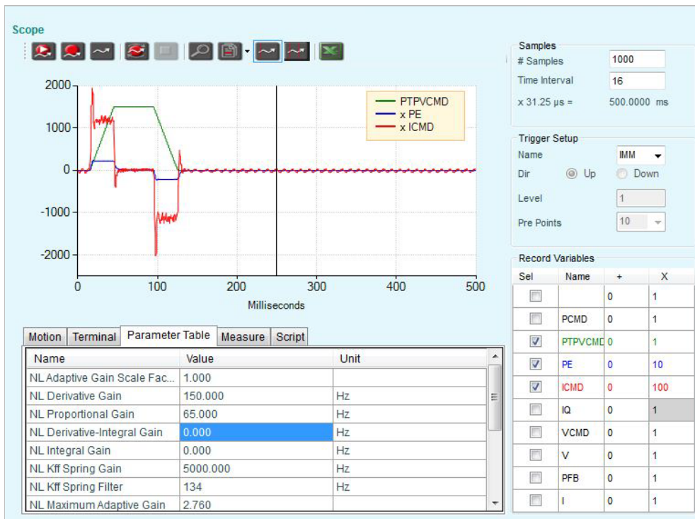
图 12-17. KNLP 65 Hz - P 位置误差继续减小, 并且在加减速过程中变得平整
