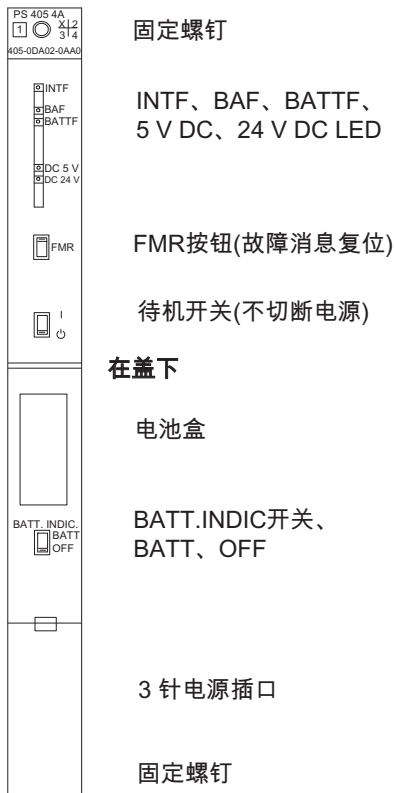
图 3-9 PS 405 4A 操作员控件和监视元件
