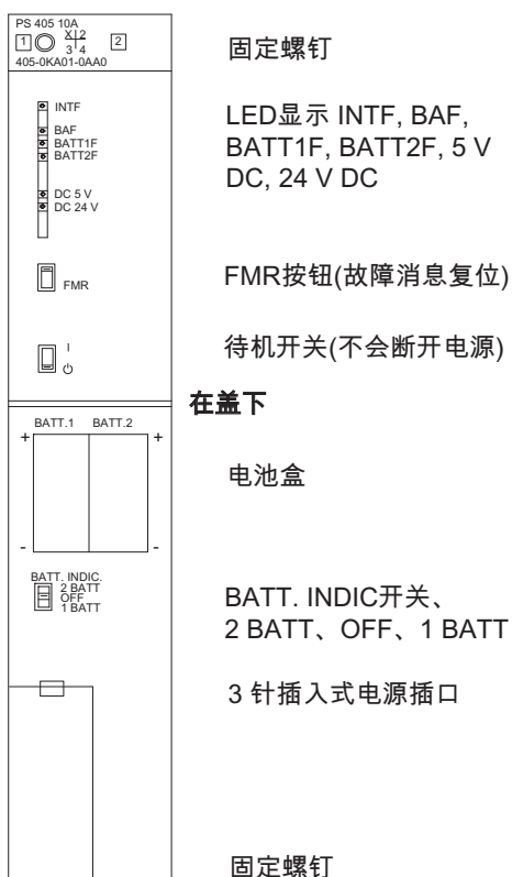
图 3-10 PS 405 10A 和 PS 405 10A R 操作员控件和监视元件
