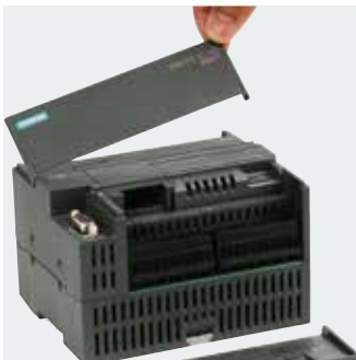
卸掉端子盖板
