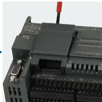
用螺丝刀卸掉空盖板
