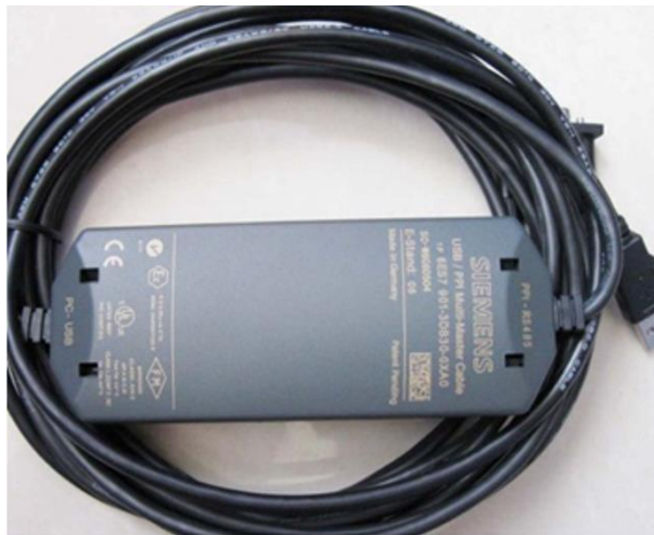
图 1-1 西门子原装 USB-PPI 电缆
