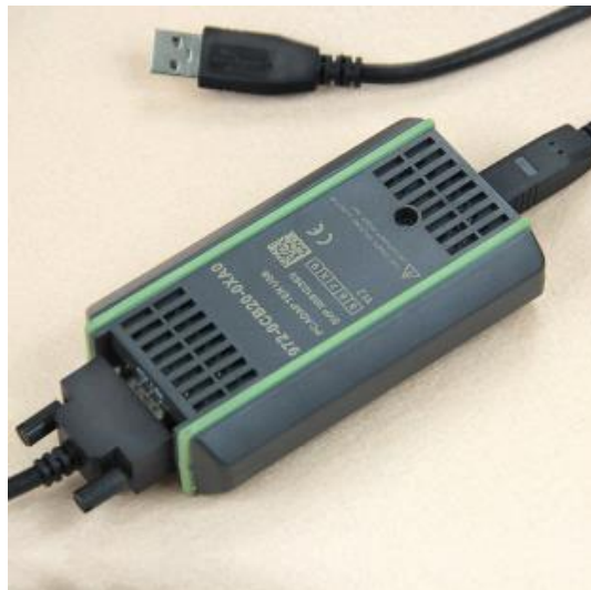
图 1-3 PC ADAPTER USB 编程电缆
