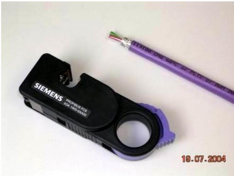
图 1. 剥好一端的 PROFIBUS 电缆与快速剥线器（FCS，订货号 6GK1905-6AA00）。
