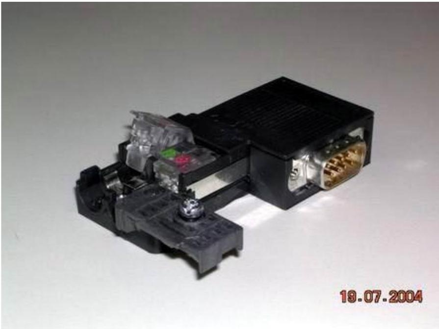
图 2. 打开的 PROFIBUS 连接器
