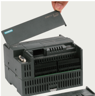
卸掉端子盖板
