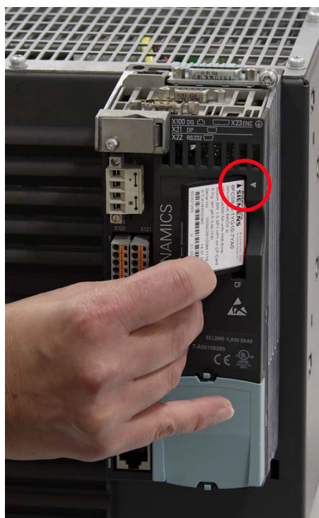
图 7-12 在 CU310-2 DP 中插入存储卡
