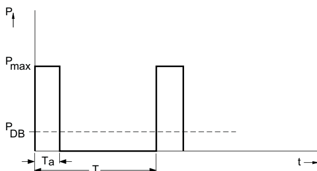
图 5-5 用于模块型制动电阻的负载示意图
