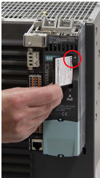
图 7-5 在 CU310-2 PN 中插入存储卡
