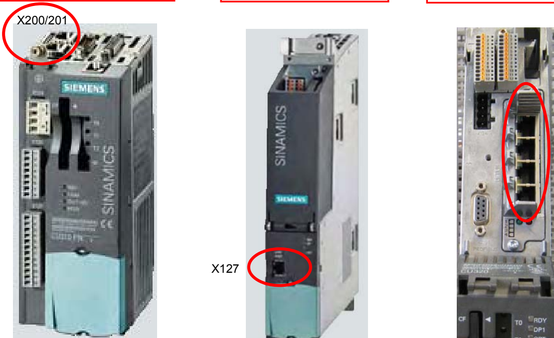
图 21 S120 各种控制单元上 PN 口或以太网口的位置
