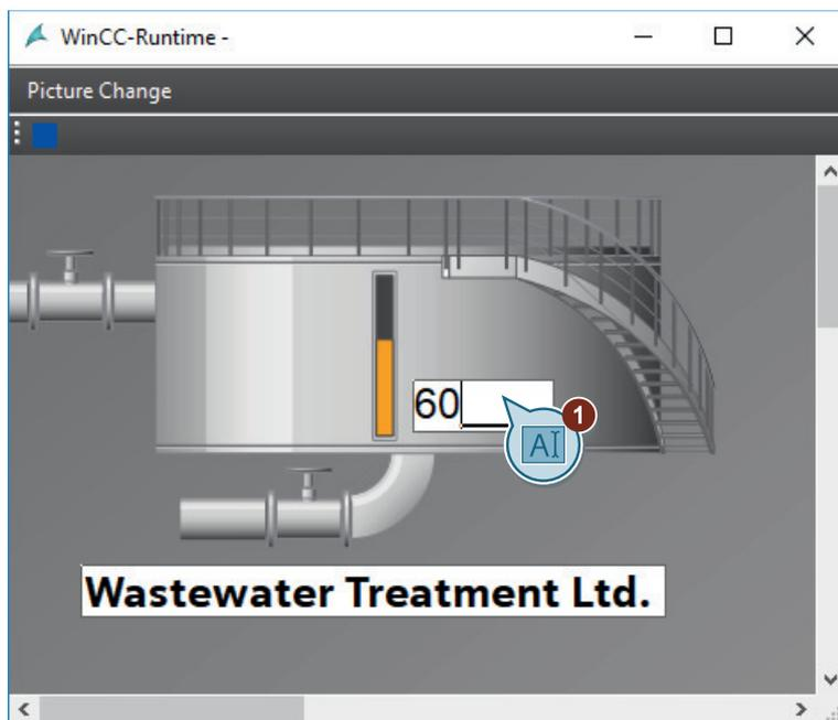
2. 在 I/O 域中输入 0 到 100 之间的值，并用 <回车> 键确认输入。观察填充量指示器中的变化。
