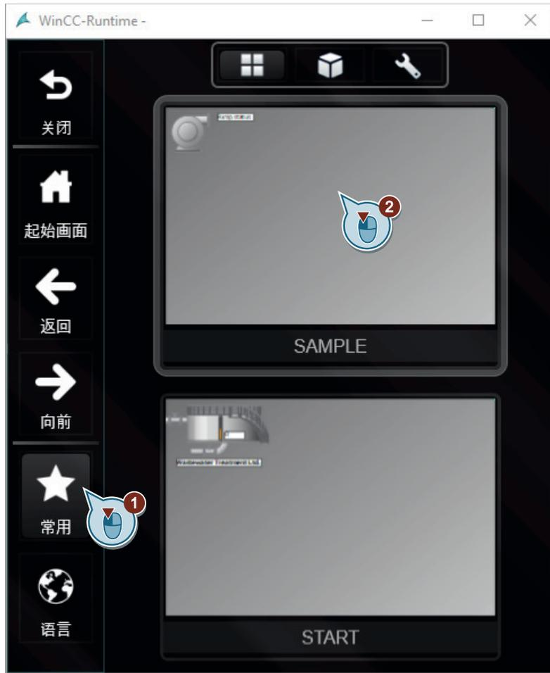
运行系统对话框将被隐藏，将显示“SAMPLE.pdl”过程画面。
