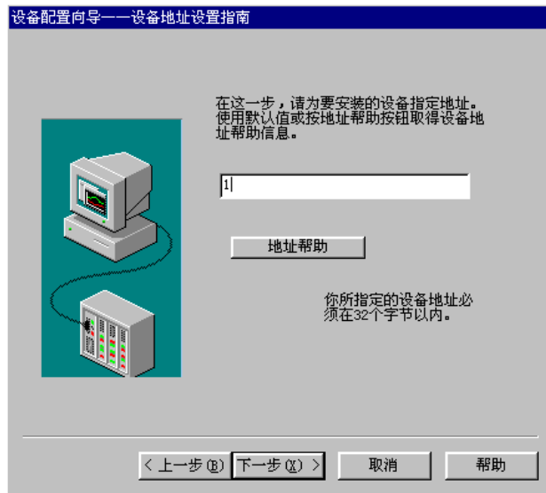
图6.24 填入PLC 设备地址
