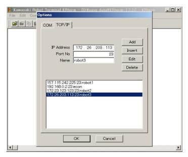
IP address (IP地址) 输入要连接的机器人的IP地址。
