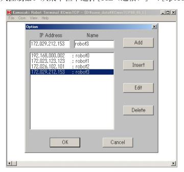
在显示的窗口中,输入网络上的IP地址和机器人控制器名并点击(OK)。(可以登录几个。)
