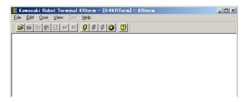
登录要连接的机器人控制器。从菜单栏中选择[Com(通信)]→[0ptions(选项)]。 在显示的窗口中,输入网络上的IP地址和机器人控制器名并点击〈OK〉。(可以登录几个。)
