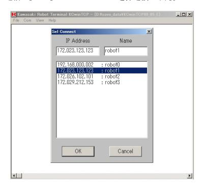
用光标键选择要连接的机器人的IP地址。点击〈OK〉。
