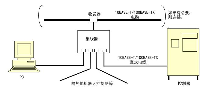
在此情况下,用 10BASE-T/100BASE-TX直式电缆连接。
