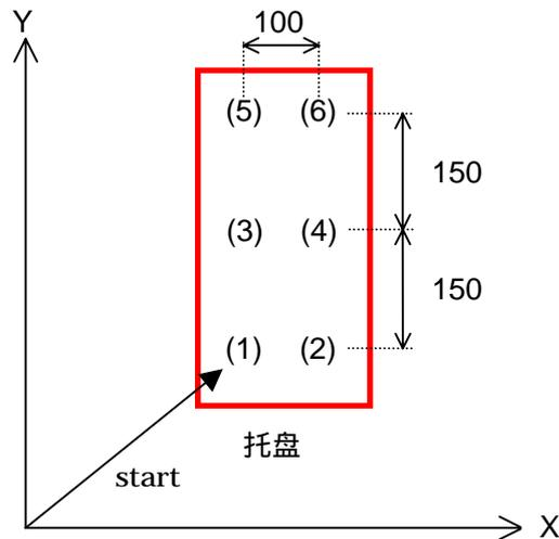
在上述例子中，零件按照从(1)到(6)的顺序进行码垛。这时，应该使用下面的程序来初始化设置。本例中托盘被放置成与机器人的基础坐标系平行。
