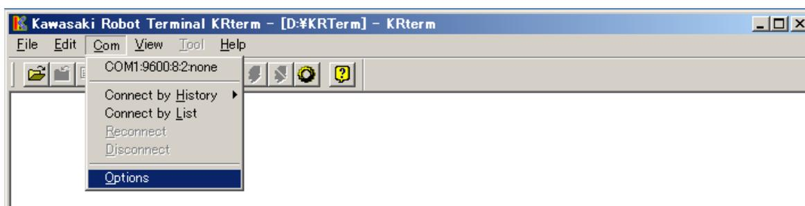
4. 向 <Baud Rate> , <Date Bits> , <Stop Bits> , <Parity> 里分别输入 9600, 8, 2, “none”。对于 KRterm 软件, 请选择 <COM> 并同样地设定参数, 然后点击 <OK> 。
