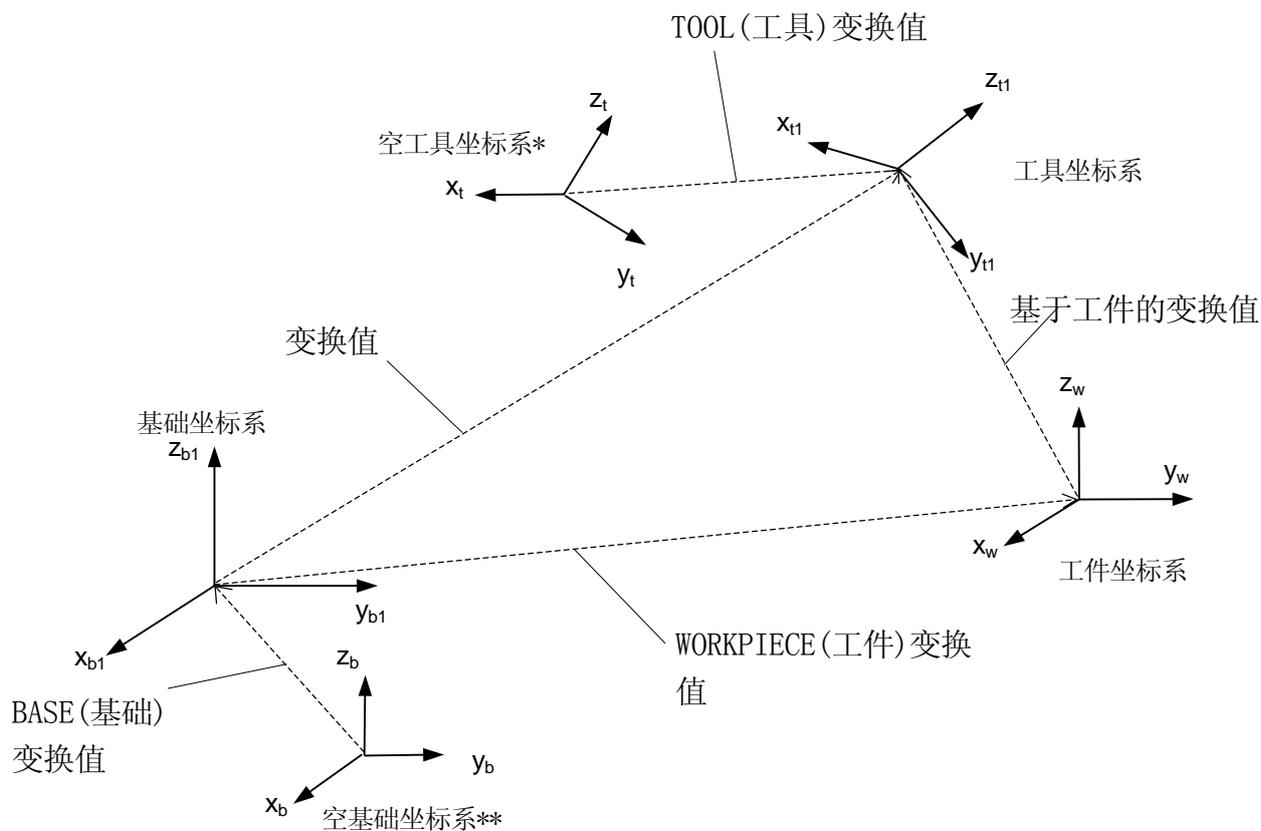
**注释\*** 空工具坐标系有他们自己的原点，此原点在机器人工具安装法兰表面的中心，它们用 TOOL (工具) 变换值(0, 0, 0, 0, 0, 0) 描述。
