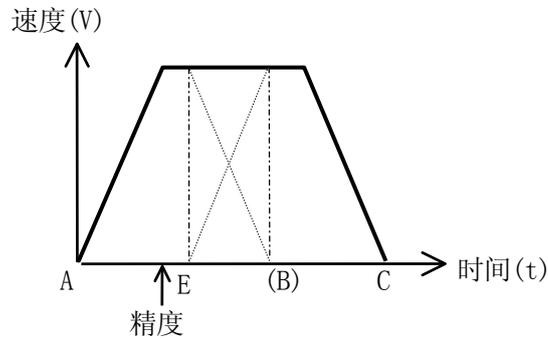
即使减速度减小而下一个路径的加速度增加，复合速度也将不会超过指定的最大速度，因为机器人直到点 F(加速度开始的点) 重叠才开始。换句话说，完成减速和加速的时间是相同的(点 B)。
