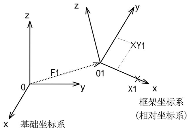
如果在框架坐标系中的位姿被示教为  $F1+A$ ，则当坐标系改变时(例如零件站移动了)，只需重新示教  $F1$ 。(参看 11.6 用框架坐标表示相对位姿)。
