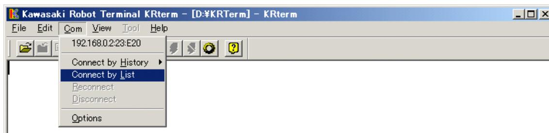
(2)对于 KRterm 软件，点击[TCP/IP] 并输入要联网的机器人控制器的 IP 地址和名称（可选的）。点击<Add>。
