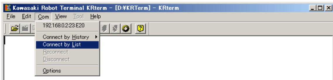
选择要联接的机器人并点击<CONNECT>(<连接>)按钮。
