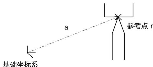
4. 安装工具到法兰上，并手动移动工具中心点(TCP)到参考点，使新工具坐标系的 Z 轴垂直于基础坐标系的 X 轴和 Y 轴。
