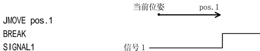
JMOVE 命令开始移动机器人向 pos.1 运动。接下来, 执行 BREAK 命令。这条命令挂起程序的执行, 直到 pos.1 的移动完成。因此, 外部信号在机器人停止前不输出。
