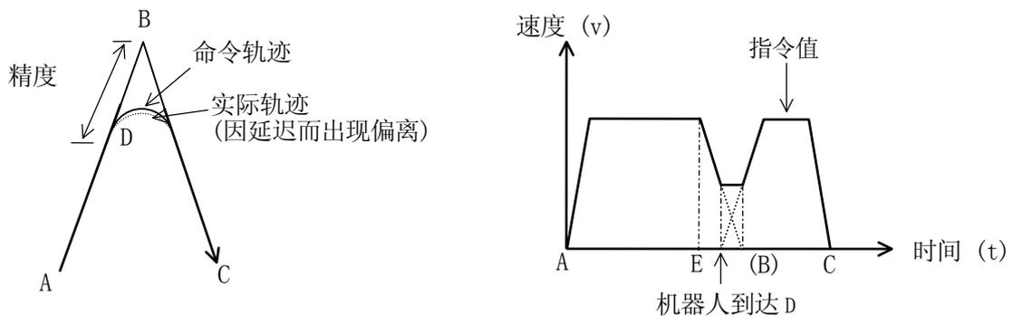
由 ACCURACY 指定得精度范围越大，重叠开始得越早。但是，下一个路径的加速不会在机器人开始减速的地方(点 E)之前开始。因此可以说，ACCURACY 作用在到达一定值时饱和，例如如果设置的精度值大于了点 B 和 E 之间的距离，此精度值将不起作用。（见下图）
