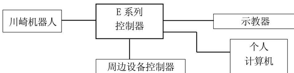
在连接一台装有川崎终端软件 (KRterm 或 KCwin32/ KCwinTCP) 的个人计算机到一台 E 系列控制器后，可以实现以下操作
