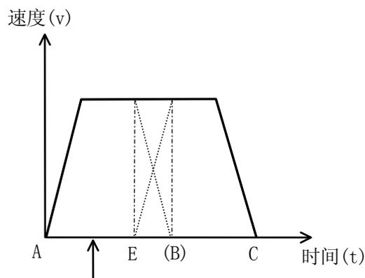
即使命令值此刻已到达精度点，下一个路径的加速仍不会开始，直到点 E 处的减速开始。
