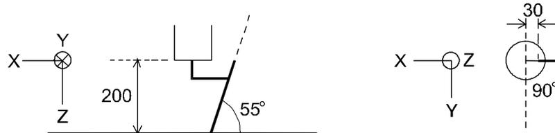
上图中所示的 XYZ 轴为空工件坐标系。下面的过程把工具坐标系的原点设置在焊炬的顶端上，并且将 Z 轴设置成与焊枪方向一致。
