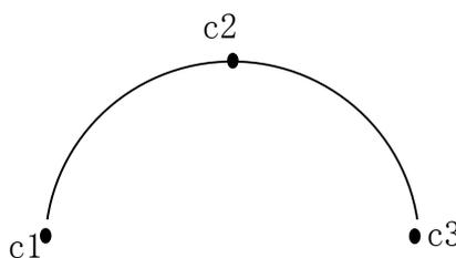
机器人以关节插补方式运动到 c1，然后沿着由 c1、c2、c3 形成的圆弧作圆弧插补运动。
