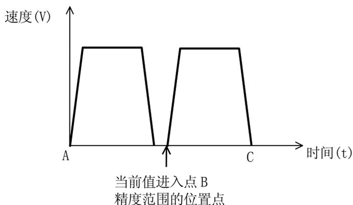
当 CP 开关为 OFF 时，第二条路径只有在第一个运动的速度减到 0 时才开始运动，即使精度范围被设置得大于第一条路径的末端。
