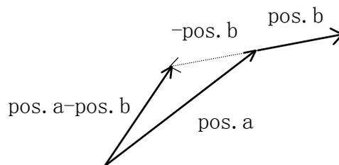
变换值运算符“-”用于一个值(例如 $-\text{pos. b}$ )，表示  $\text{pos. b}$  的反向值。例如，当变换值  $\text{pos. b}$  定义了对象 B 相对于对象 A 的姿态，那末  $-\text{pos. b}$  则定义了对象 A 相对于对象 B 的姿态。
