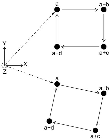
在右边的图(A)，示教了参考点 a 和其他角的复合变换值。在图(B)中，参考点 a 被重新定义。如果机器人工具的定向不重新设定(即与图(A)中保持相同的定向)，机器人将沿实线所示的轨迹移动。如果希望机器人沿虚线移动，就必须重新定义定向和位置。
