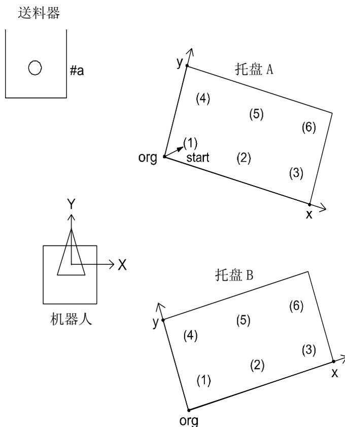
第一步是将零件放在托盘 A 上。示教托盘的 3 个角，一个作为原点(origin)，其余两点分别作为 X 轴和 Y 轴上的点(见上图)。执行以下程序将零件码放在托盘 A 上(请注意：在定义完点以后，程序的其他部分与以前的示例程序是一样的)。为了在托盘 B 上码放零件，重新示教 3 个角，并执行相同的程序。框架坐标系将被重新定义，零件将像在托盘 A 上一样被码放在托盘 B 上。
