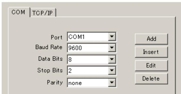
其次，选择[Com(munication)]→[Connect by List]，以下的画面出现，选择以上设定好的连接设定。点击〈OK〉。
