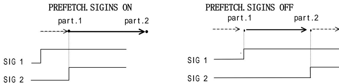
当 PREFETCH. SIGINS 为 ON 时，只要机器人开始向 part1 移动，外部信号 1 (SIGNAL 1) 立即被输出。当程序到达第二个 JMOVE 命令时，等待直到机器人到达 part1，然后执行该命令。一旦机器人到达 part1，它开始移向 part2，同时，外部信号 2 (SIGNAL 2) 被输出。
