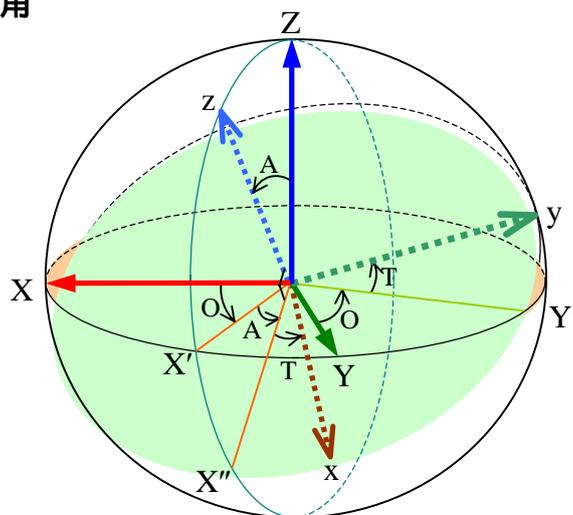
坐标系  $\Sigma(x, y, z)$  相对于基础坐标系  $\Sigma(X, Y, Z)$  的姿态，通常用欧拉 OAT 角来表达。如上图所示，三个角可以定义为如下。在上图中，两个坐标系  $\Sigma(x, y, z)$  和  $\Sigma(X, Y, Z)$  具有相同的原点。
