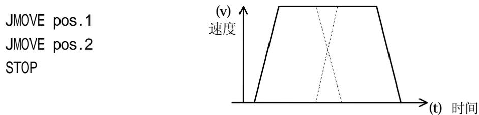
像这样的运动，机器人执行了一系列的运动，在运动段之间作出了平滑的转向，而并不在各目标位姿停止，被称为 CP (连续路径) 运动。将 CP 系统开关设置为 OFF，可禁止 CP 功能。如果 CP 开关为 OFF，机器人将在每个动作段的结束处减速并停止。(见 5.6 中 SWITCH 和 ON/OFF 指令，6.9 中如何设置 CP 开关的 ON/OFF 命令)
