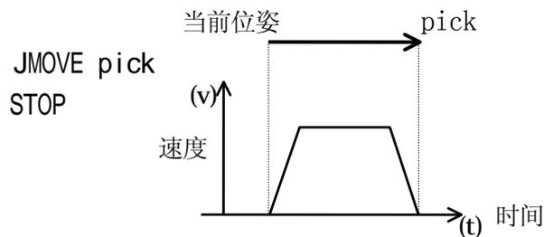
当执行上述运动命令时，机器人在向“pick”移动的同时，平滑地加速到当前设置的速度。当机器人接近“pick”时，它逐渐减速直到停在那个位姿上。一系列这样的动作，由一条运动命令执行，被称为一个“运动段”。
