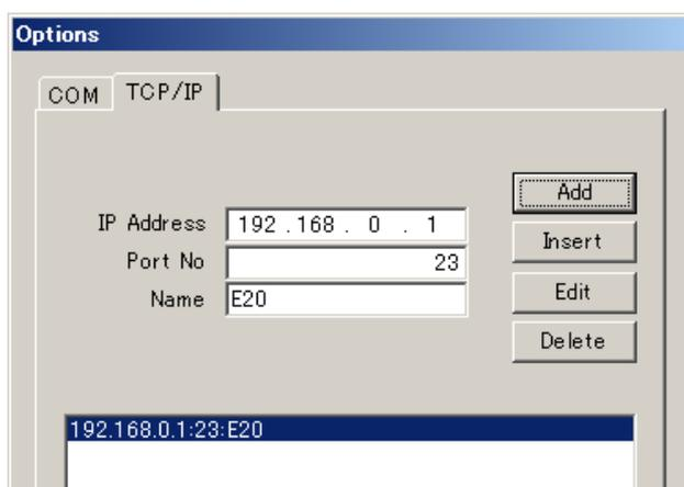
对于 KCwinTCP 软件，屏幕显示如下。输入要联网的机器人控制器的 IP 地址和名称（可选的），然后点击<Add>。
