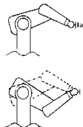
要解决这些问题，有必要改变机器人在运动中的形态。无论何时，当一条关节运动命令(关节插值运动命令：JMOVE, JAPPRO, JDEPART, DRIVE 等)以一个由变换值定义的点作为结束的时候，可以通过执行一条形态命令来实现这一改变。这里列出 6 条形态命令，程序示例在下几页的注意框中给出。
