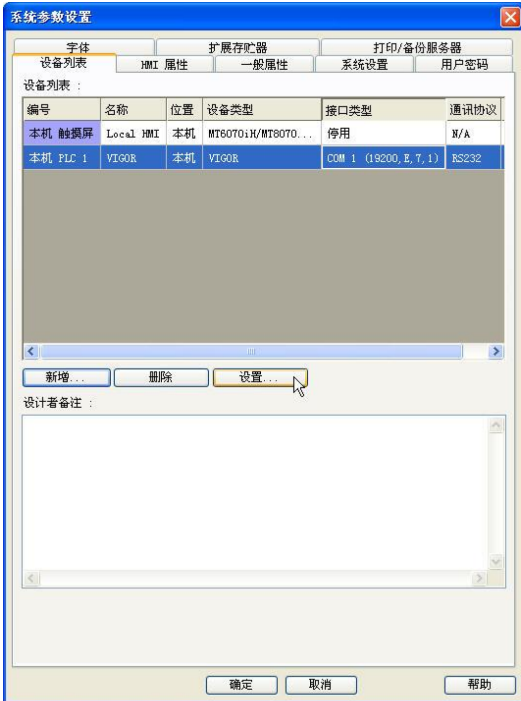
图4 添加PLC驱动设备
