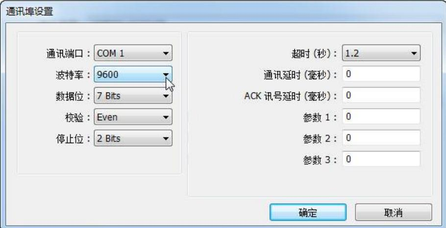
注意：若想提高通讯速率，可提高波特率设置，如 57600bps；此时若偶尔出现 PLC No Response 提示，请适当修改通讯延时、ACK 讯号延时，如分别设为 2ms、3ms。
