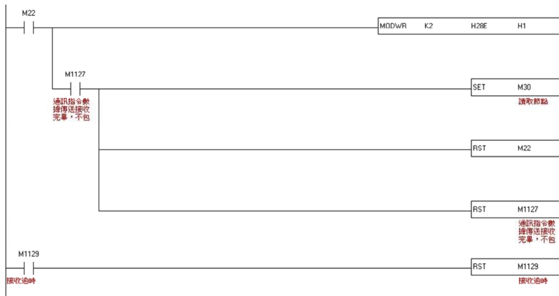
圖 4.6.5 利用參數設定進行絕對值座標初始化的 PLC 設定
