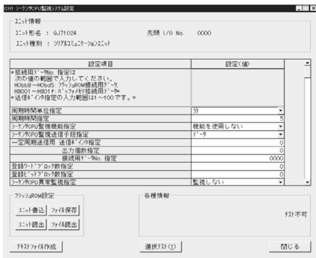
可编程控制器CPU监视系统设置的屏幕样例
