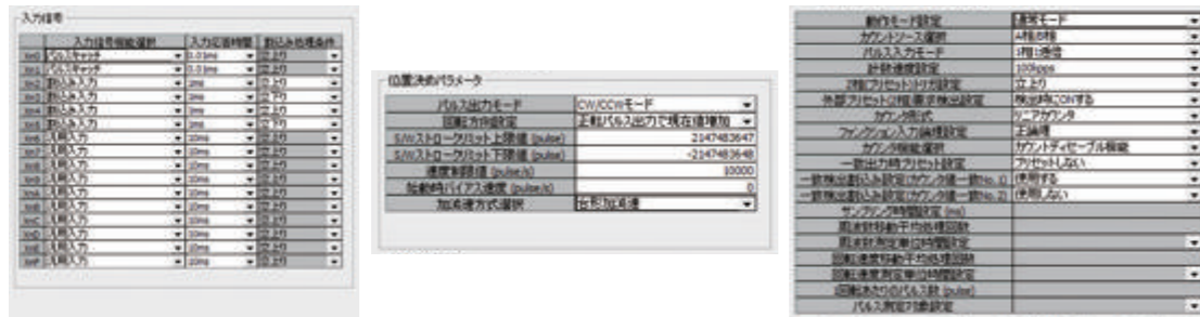
[CPU内置I/O功能的参数设定示例] 脉冲捕捉：0.01ms(输入响应时间) 中断输入：1ms(输入响应时间)
