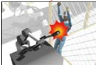
在投入材料时等情况下,材料附近的人有被机器人夹住的危险。
