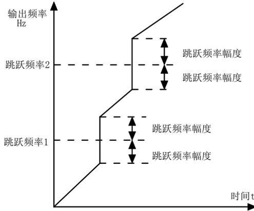
图 6-18 加减速过程中跳跃频率有效示意图
