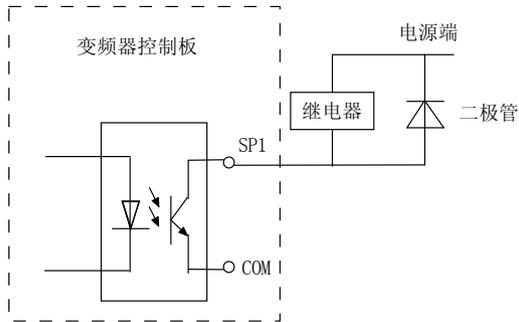
图 3-14 数字输出端子接线示意图
