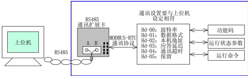
图 4-7 变频器串行通讯的使用
