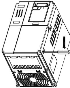
图 3-2 塑胶外壳下面板拆卸图
