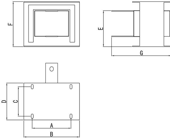
图 2-11 外置电抗器尺寸示意图
