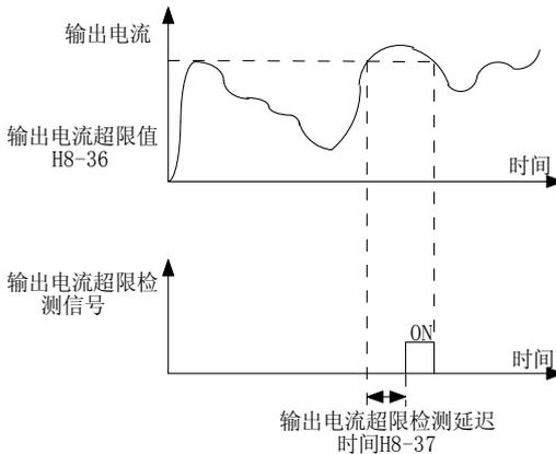
图 6-22 输出电流超限检测示意
