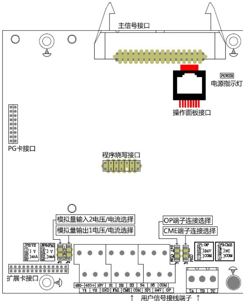
图 3-4 S580 系列控制板 (CPU500) 布局图
