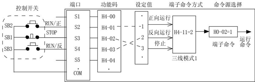
图4-5 端子启停控制方式举例
