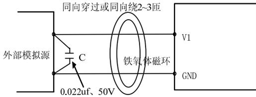
图 3-10 模拟量输入端子处理接线图
