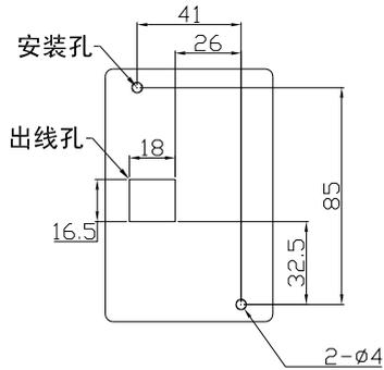
图 2-6 键盘背面固定开孔尺寸图
