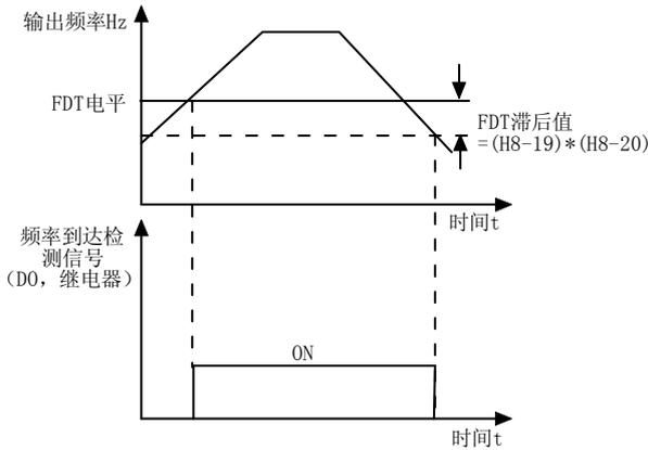
图 6-16 FDT 电平示意图
