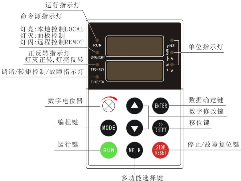
图 4-1 键盘 1 操作面板示意图
