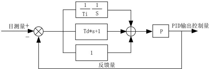
图 6-26 过程 PID 原理框图
