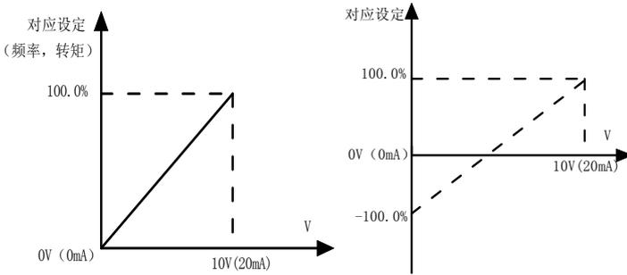
图 6-10 模拟给定与设定量的对应关系
