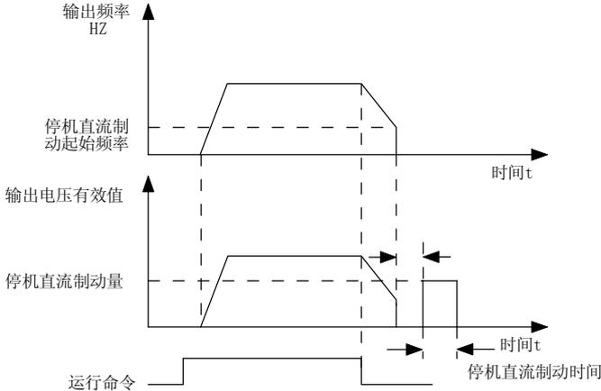
图 6-13 停机直流制动示意图
