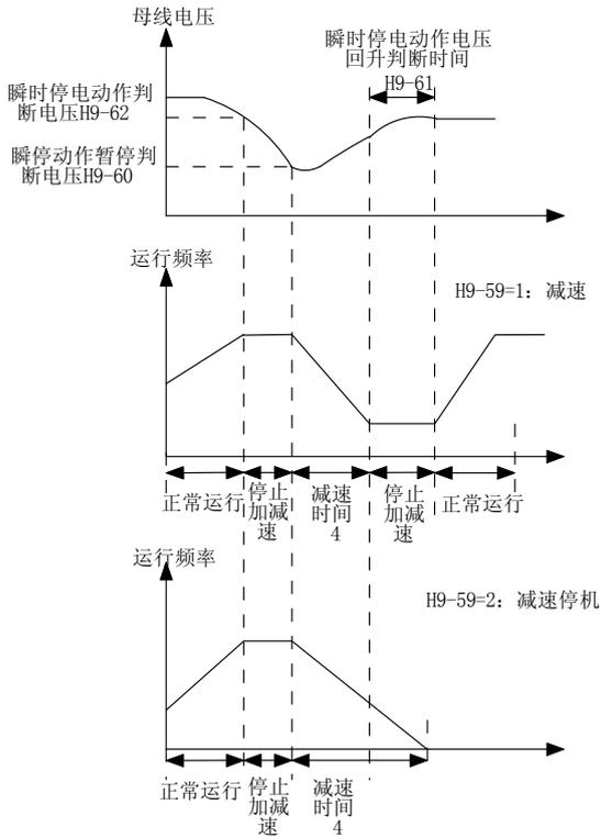
图 6-25 瞬时停电动作示意图
