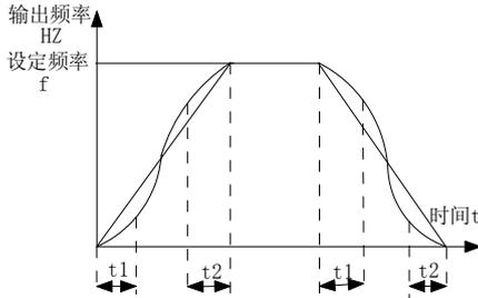
图 6-11 S 曲线加减速 A 示意图
