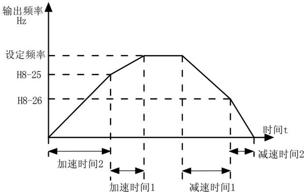
图 6-19 加减速时间切换示意图
