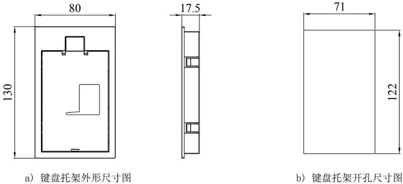
图 2-7 键盘托架外形尺寸及开孔尺寸图
