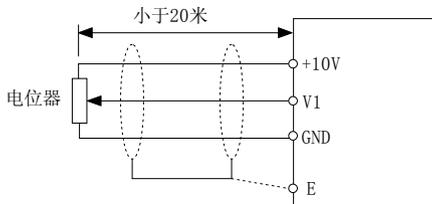
图 3-9 模拟量输入端子接线示意图
