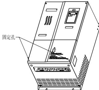
图 3-3 钣金外壳下面板拆卸图
