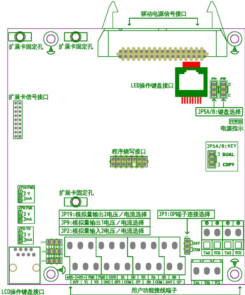
图 3-5 S580 系列控制板 (CPU500-X) 布局图
