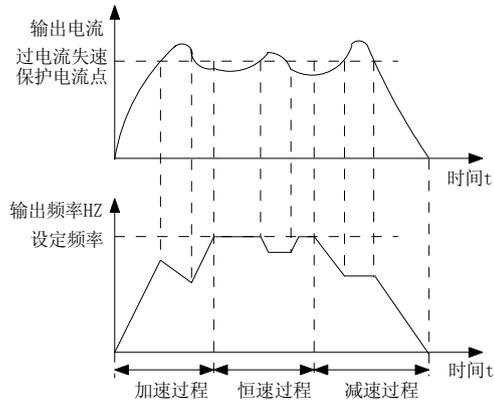
图 6-24 过流失速保护示意图
