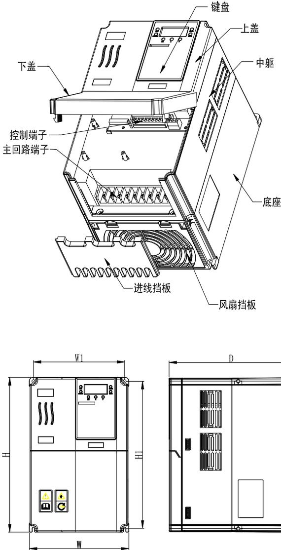
图 2-3 7.5KW~15KW 壁挂式塑料结构外形及尺寸示意图
