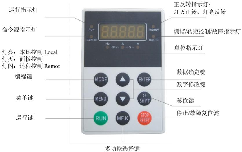
图 4-2 键盘 2 操作面板示意图
