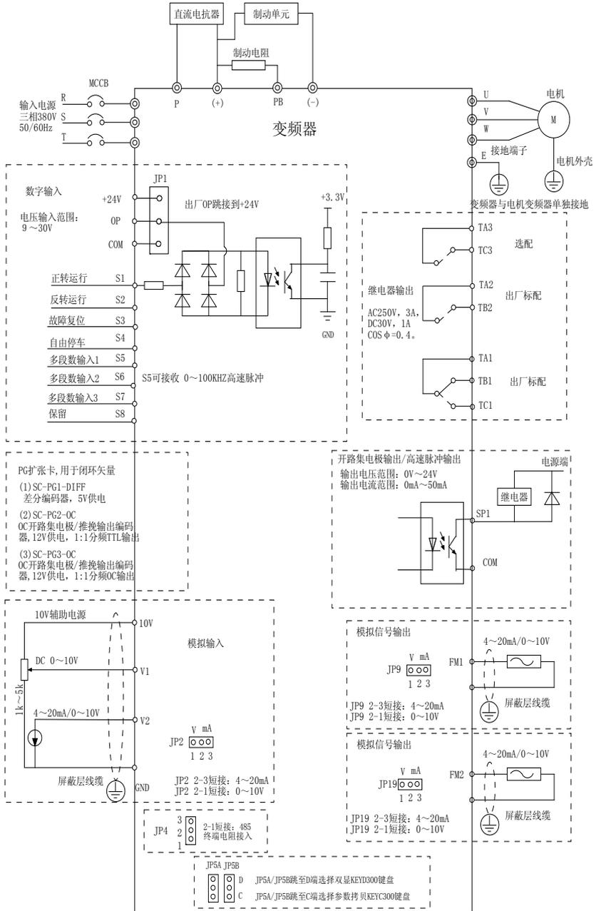
图 3-6 变频器接线示意图
