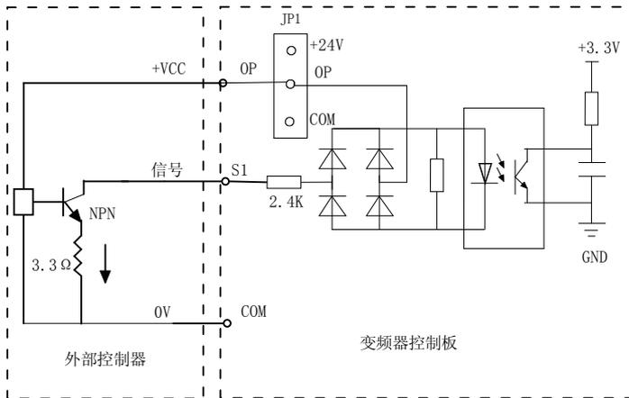
图 3-11 漏型接线方式
