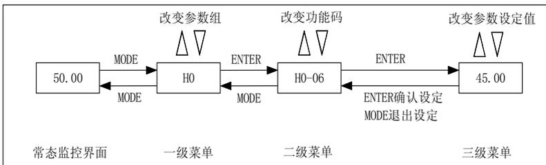
图 4-3 三级菜单操作流程图
