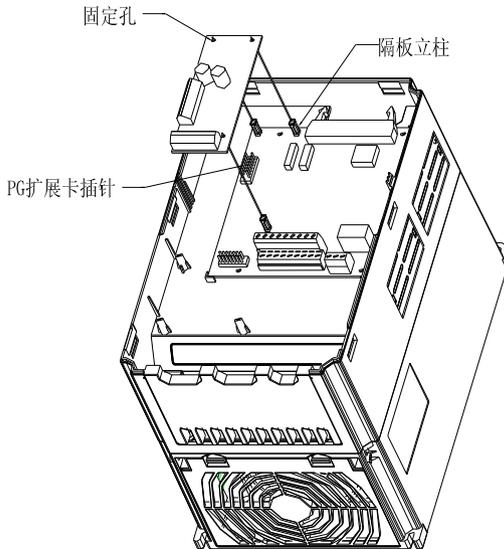
附录 C: 图 1 PG 卡 2 SC-PG2-0C 安装方式
