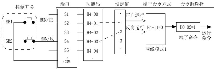
图 4-4 端子启停控制方式举例
