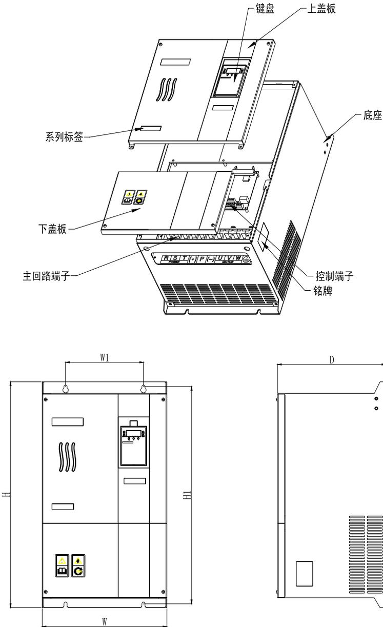
图 2-4 变频器 18.5KW~400KW 钣金结构外形及尺寸示意图
