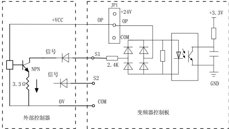
图 3-12 多台变频器 S 端子并接漏型接线方式
