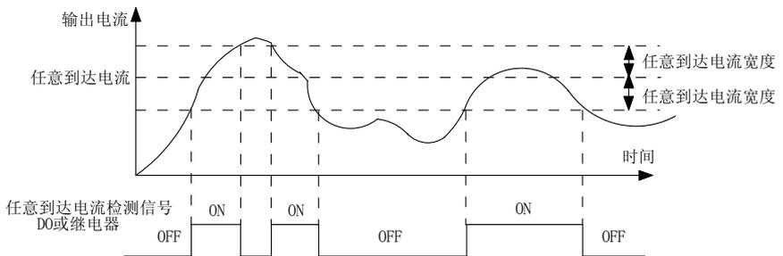
图 6-23 任意到达电流检测示意图
