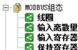
图 51 MODBUS 变量区
