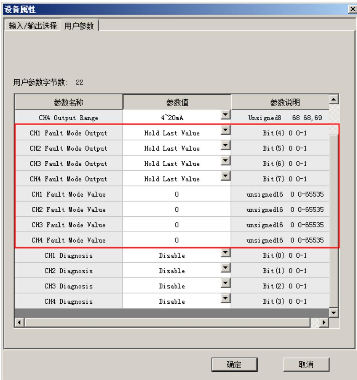
图 187 故障模式输出设置
