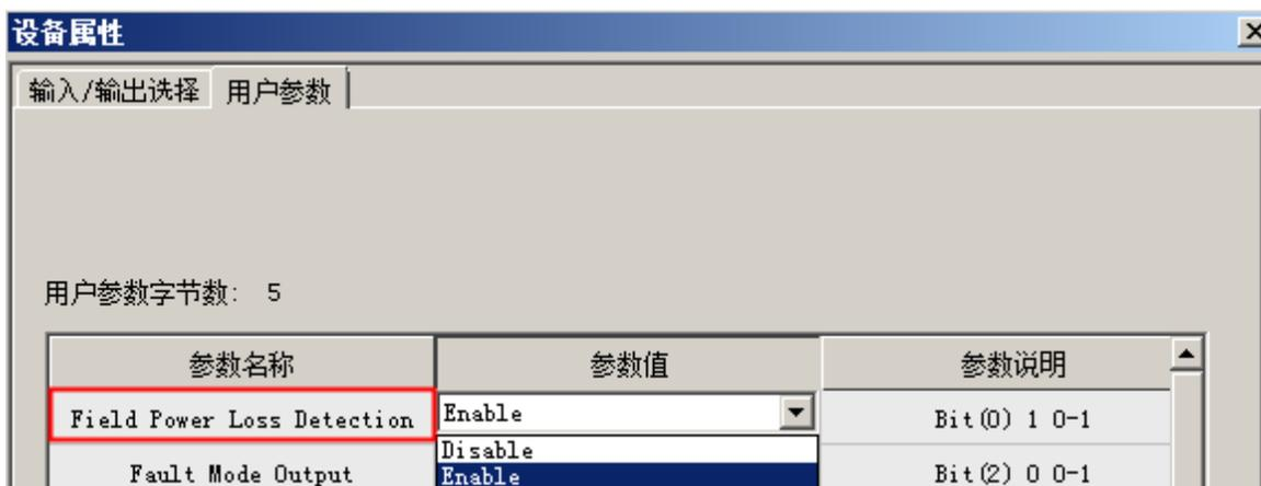
图 150 LK710 掉电检测使能设置
