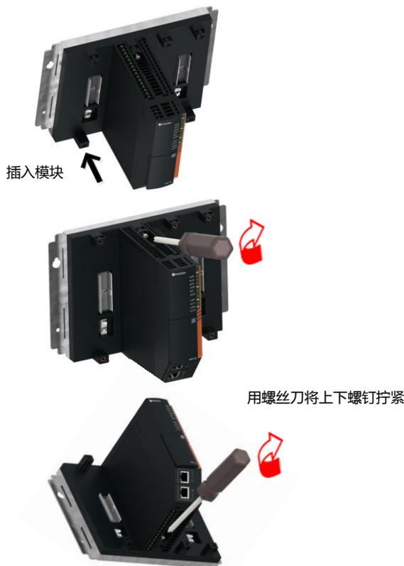
图 11 LKS 模块的安装
