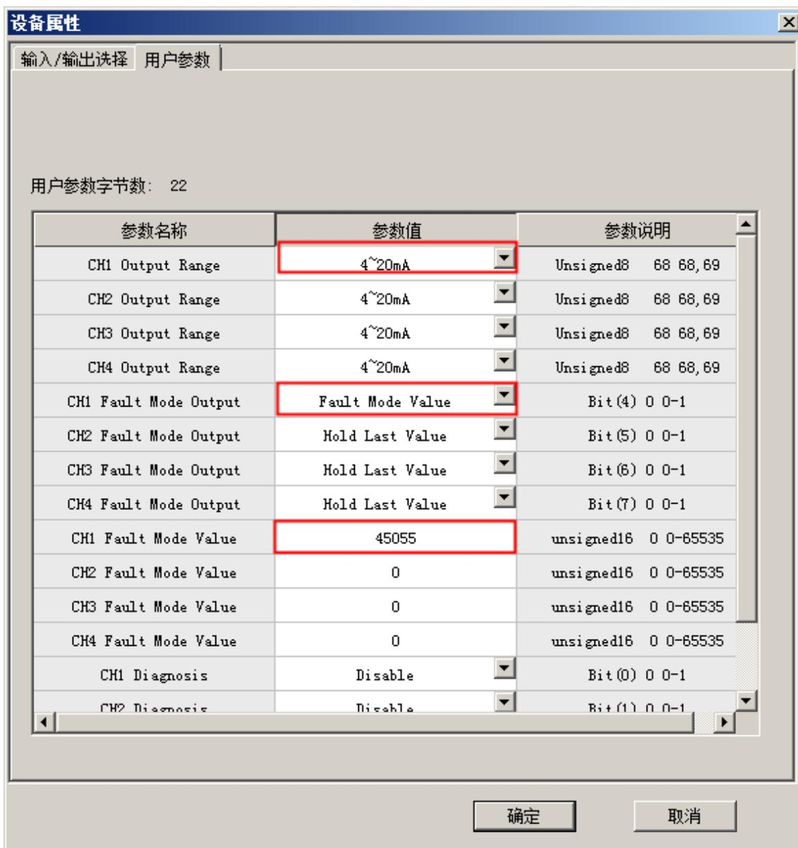
图 186 选定量程下故障模式参数设置示例
